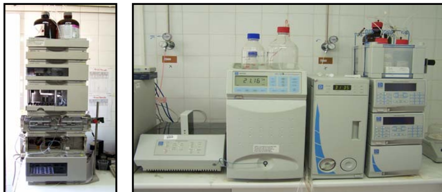
Figura 3. Fotografía del HPLC (Agilent Technologies serie 1100) y los cromatógrafos iónicos (DX120 Y DX600) en el laboratorio de la PSA.
