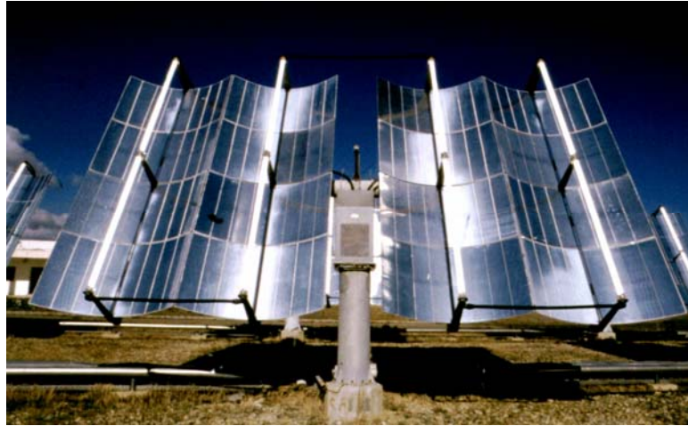
Figura 6. Colector Cilindro-Parabólico con seguimiento en dos ejes instalado en la PSA.
