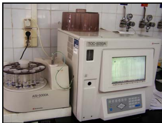
Figura 2. Fotografía del Analizador de Carbono Orgánico Total Shimadzu 5050A instalado en el laboratorio de la PSA.
