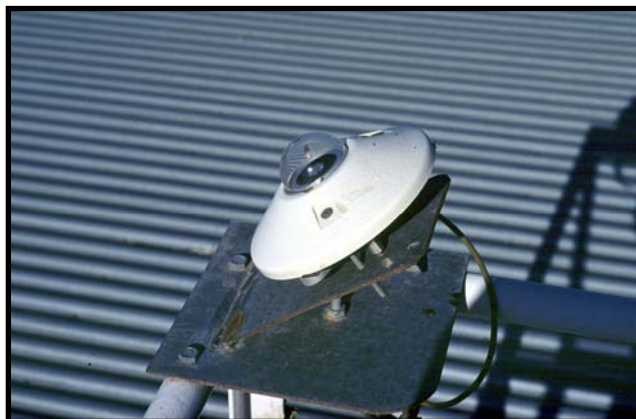
Figura 3.2. Fotografía del radiómetro de UV global empleado en los ensayos realizados en la Plataforma Solar de Almería.
