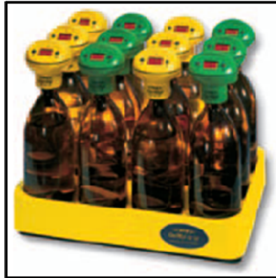
Figura 3.6. Biómetros para la determinación de la DBO_5 dispuestos sobre un sistema de agitación.
