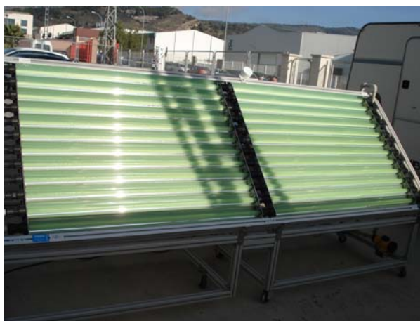
Figura 4.19 Planta piloto de fotocatalisis solar de 50L
