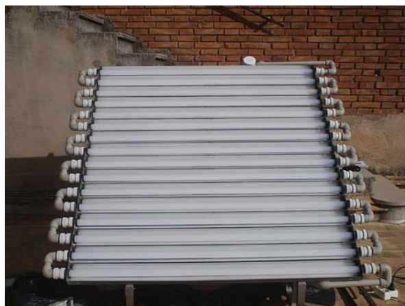
Figura 4.18. Planta piloto de fotocátalisis solar de 24L
