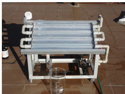
Figura 4.19. Planta piloto de fotocátalisis solar de 4 L.
