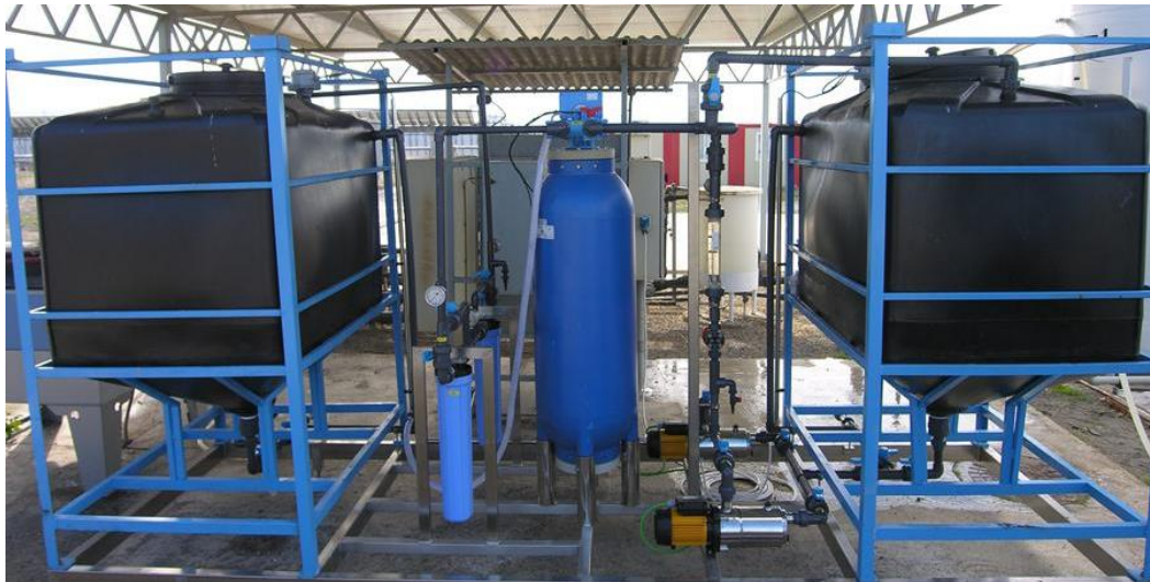
Figura 28. Planta piloto de filtración/floculación para el tratamiento de efluentes de EDAR o industriales previo al sistema de membranas.
