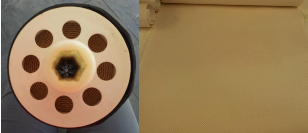
Figura 3.16. Entrada de la alimentación (Izquierda). Superficie desenrollada de la membrana utilizada con efluente de EDAR (Derecha).
