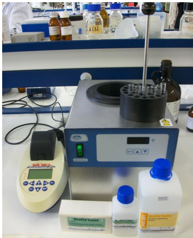
Figura 2.21. Termoblock, Luminómetro Biofix®Lumi-10, kit BioFix®Lumi “Multi-shot” (solución reconstituyente, viales de bacteria liofilizada y solución salina 2%).
