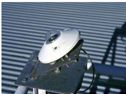
Figura 2.15. Fotografía del radiómetro de UV global empleado en los ensayos realizados en la PSA.
