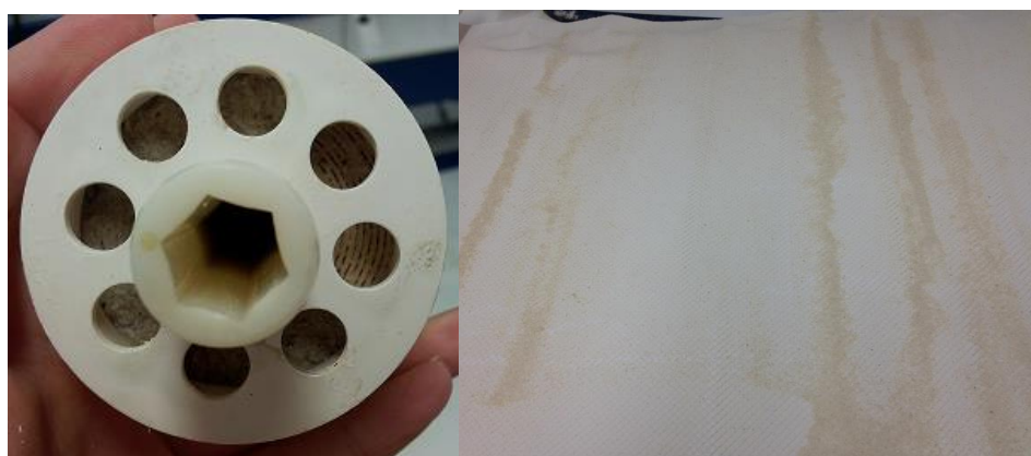
Figura 3.15. Incrustaciones de sales a la entrada de la alimentación (Izquierda). Superficie desenrollada de la membrana utilizada con agua natural (Derecha).
