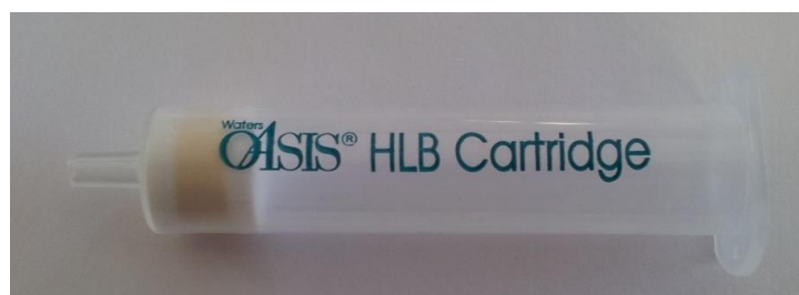
Figura 2.4. Fotografía del cartucho de SPE utilizado (6 cm 3 HLB).
