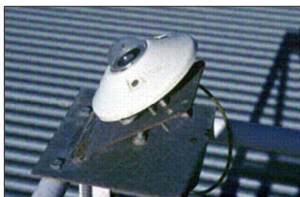
Figura 2.11 Fotografía del radiómetro de UV global empleado en los ensayos realizados en la Plataforma Solar de Almería.
