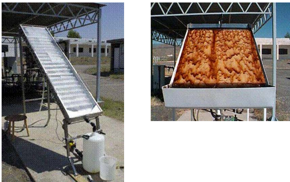
Figura 1.16 Colectores sin concentración utilizados para degradación de contaminantes mediante fotocatalisis heterogénea (izquierda) y foto Fenton (derecha), desarrollados en la PSA.
