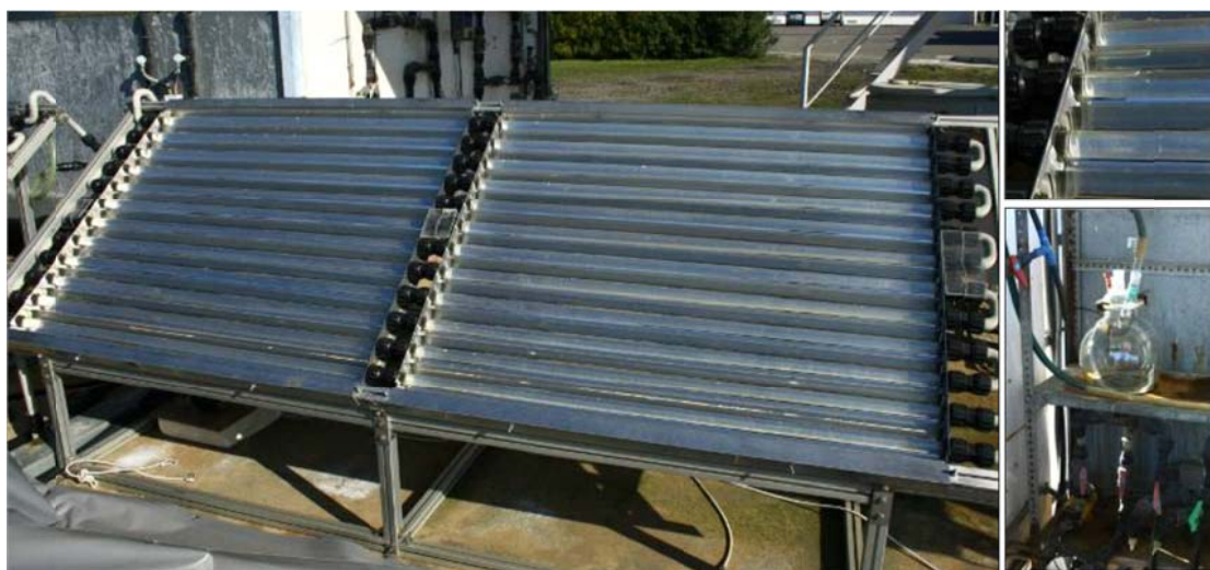
Figura 2.9 Fotografía del fotorreactor CPC con capacidad para tratar 35 L de agua (izquierda). En el detalle, fotografía de los tubos de un módulo de CPC (derecha, superior) y fotografía del tanque y bomba de recirculación (derecha, inferior).
