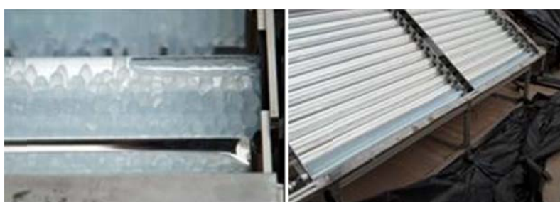
Figura 2.10 Fotografía del fotorreactor CPC utilizado para los ensayos fotocatalíticos con el sistema inmovilizado: vista general del CPC (derecha); vista en detalle del tubo relleno con esferas de vidrio (izquierda).
