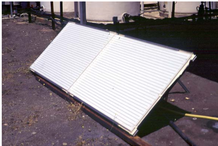
Figura 1.3.13. Instalación experimental de un colector de placa plana hueca.
