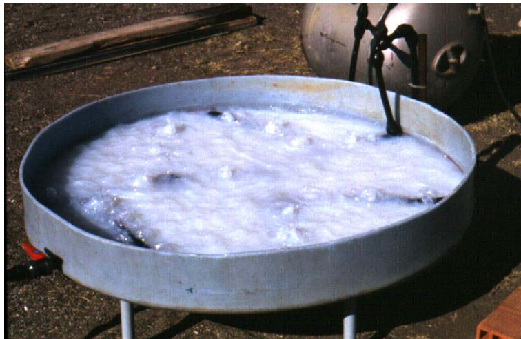
Figura 1.3.15. Instalación experimental de un colector tipo balsa superficial en la Plataforma Solar de Almería.
