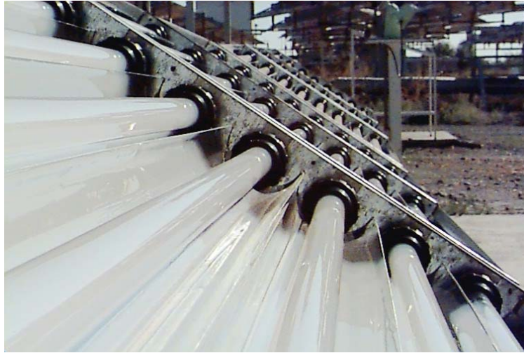
Figura 1.3.17. Detalle de un colector CPC donde se observa la configuración de los tubos reactores.
