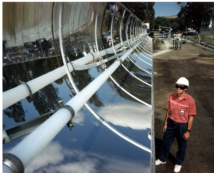
Figura 1.3.9. Colector cilindro-parabólico adaptado para fotocátalisis solar.
