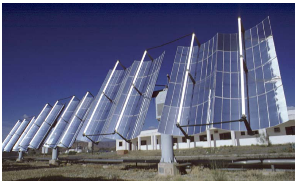
Fig. 5.7.- Colectores solares cilindro-parabólicos con seguimiento en dos ejes, modificados para tratamiento fotocatalítico de agua
