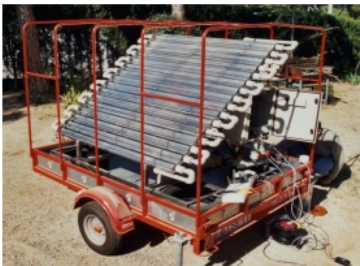
Figura 7.1.- Planta piloto móvil experimental basada en reactores con colector solar tipo CPC para la realización de estudios de viabilidad de procesos de fotocátalisis solar
