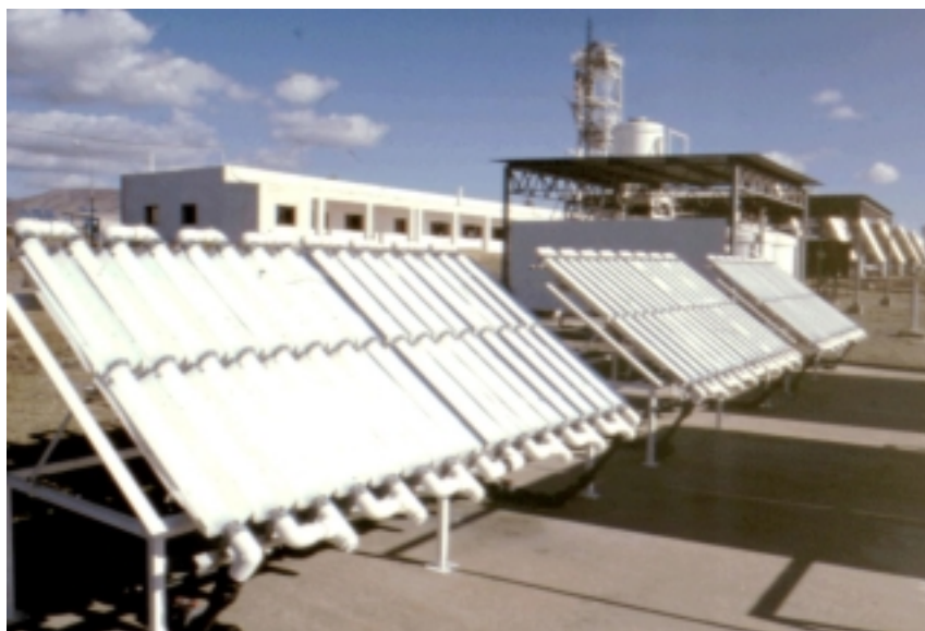
Figura 7.6.- Sistema experimental utilizado en la PSA para la realización del Estudio de Viabilidad del tratamiento fotocatalítico del agua de lavado procedente del proceso de reciclado de envases plásticos de productos fitosanitarios
