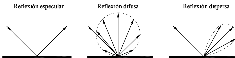
Figura 6.23.- Diferentes modalidades de reflexión de luz sobre una superficie: especular, difusa y dispersa
