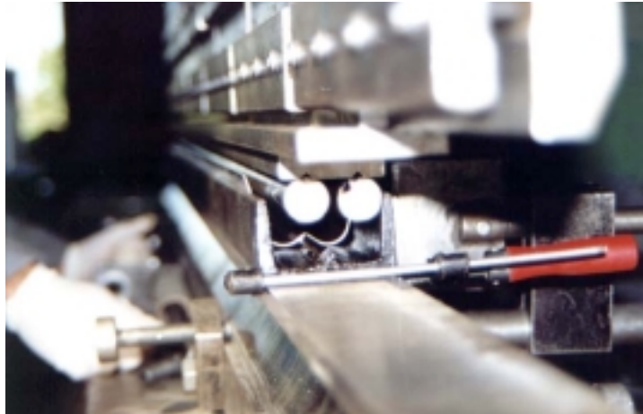
Fig. 7.21.- Conformación del CPC sobre plancha rectangular de aluminio anodizado
