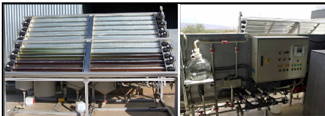
Figura 2.7 Fotografía de los cuatro módulos de concentradores CPC (izquierda) e interior de la caseta que protege al tanque de recirculación, los sensores, el sistema de calefacción y refrigeración y el cuadro eléctrico (derecha)
