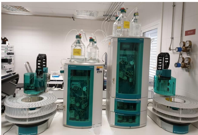
Figura III.1. Cromatógrafo iónico Metrohm IC850 y Metrohm 858 utilizados en este trabajo.
