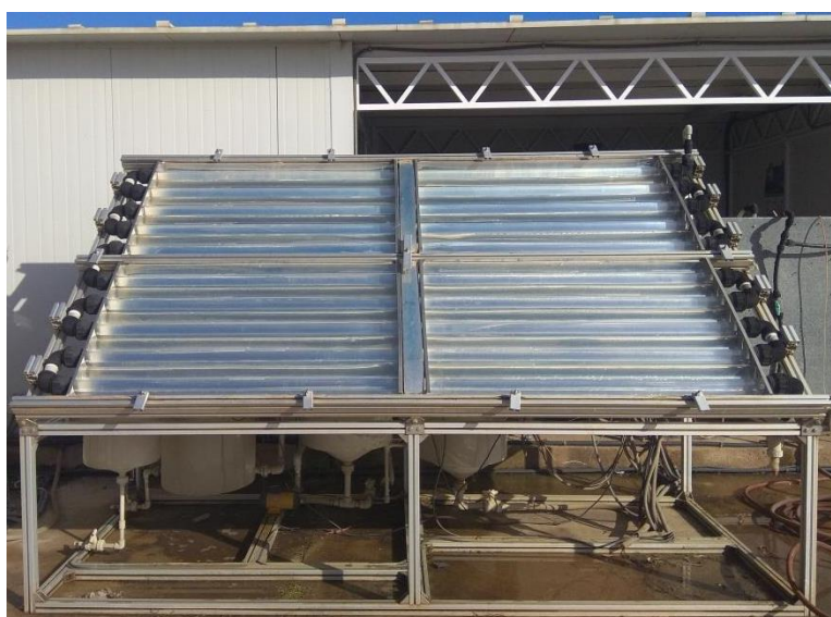
Figura III.27. Fotografía del captador CPC CADOX utilizado para reacciones de foto-Fenton solar.
