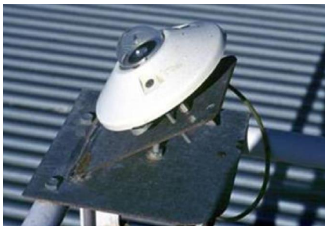
Figura III.29. Radiómetro de UV KIPP&ZONEN, modelo CUV4.
