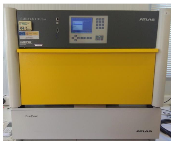
Figura III.25. Simulador solar ATLAS XLS+.
