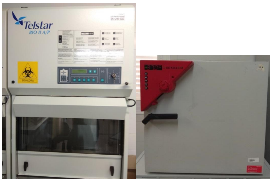
Figura III.18. Cabina de flujo laminar modelo Telstar BIO II A/P e incubadora SINDER.
