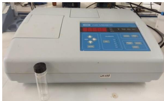
Figura III.5. Turbidímetro Hach modelo 2100N.
