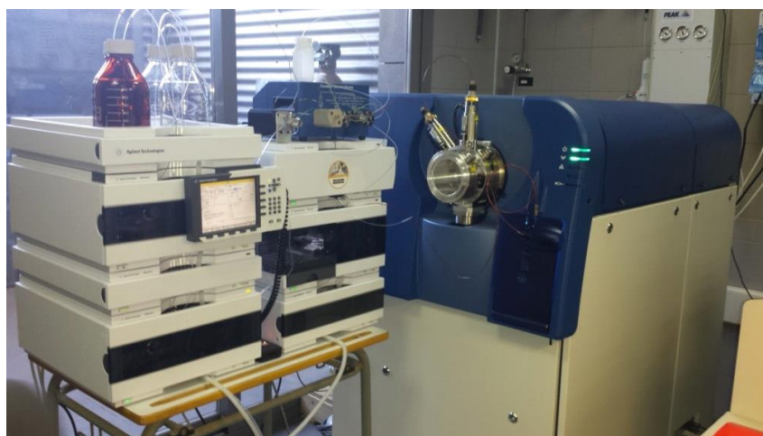
Figura III.15. Sistema LC-ESI-QTOF-MS empleado en el análisis de MC “sospechosos”.
