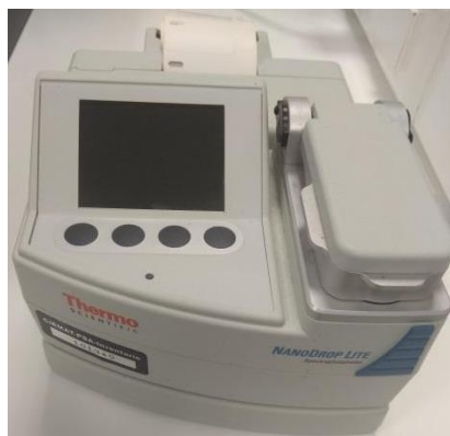
Figura III.20. NanoDrop™ Lite para la determinación de la cantidad de ADN extraído.
