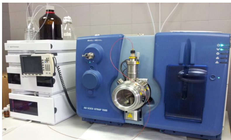
Figura III.14. Fotografía del sistema 5500 Q-TRAP® LC-MS-MS.
