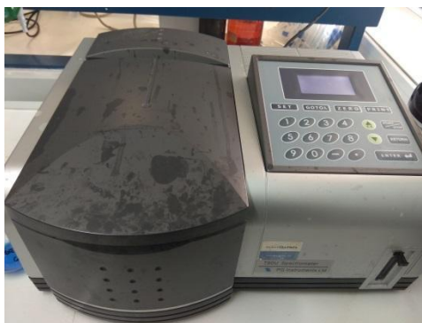
Figura III.4. Espectrofotómetro T60U, PG Instruments Ltd.
