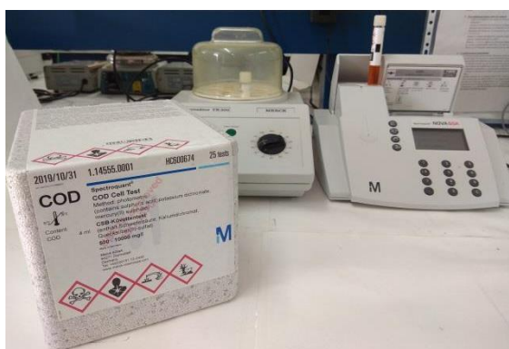
Figura III.3. Termorreactor TR 300 de Merck y espectrofotómetro NOVA 30 de Merck para la medida de la DQO.
