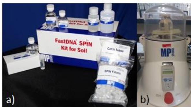
Figura III.19. a) Kit comercial utilizado para la extracción de ADN (FastDNA™ SPIN Kit for Soil) b) FastPrep® utilizado para favorecer la extracción del ADN.
