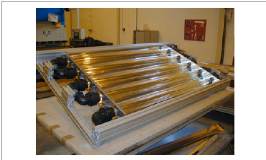
**Figura 13.** Detalle de un canal y el absorbedor tubular que se está insertando.
