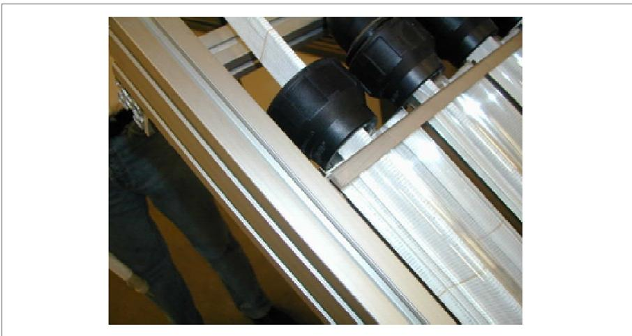
Una vez que los prototipos están llenos con agua, la apertura de entrada de arriba se vuelve completamente blanca (el color del absorbedor), lo que señala que la óptica funciona según lo que se requiere.
