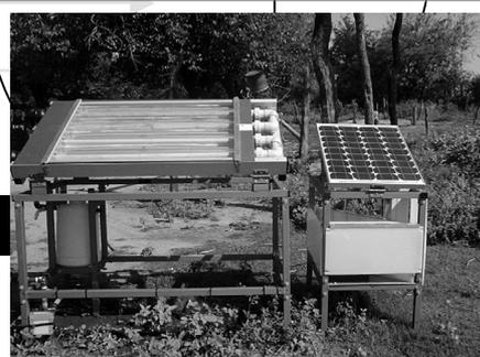
Figura 6. Prototipo de desinfección de agua «SOLWATER» instalado en una finca en el pueblo de «Los Pereyra», provincia de Tucumán, Argentina.
