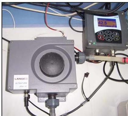
Figura 3.10. Turbidímetro Lange Ultraturb *plus SC* para medida de la turbidez del medio.
