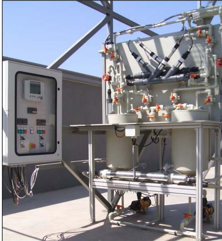
Figura 3.9. Fotografía de los tanques, sensores, bombas y panel de instrumentación.
