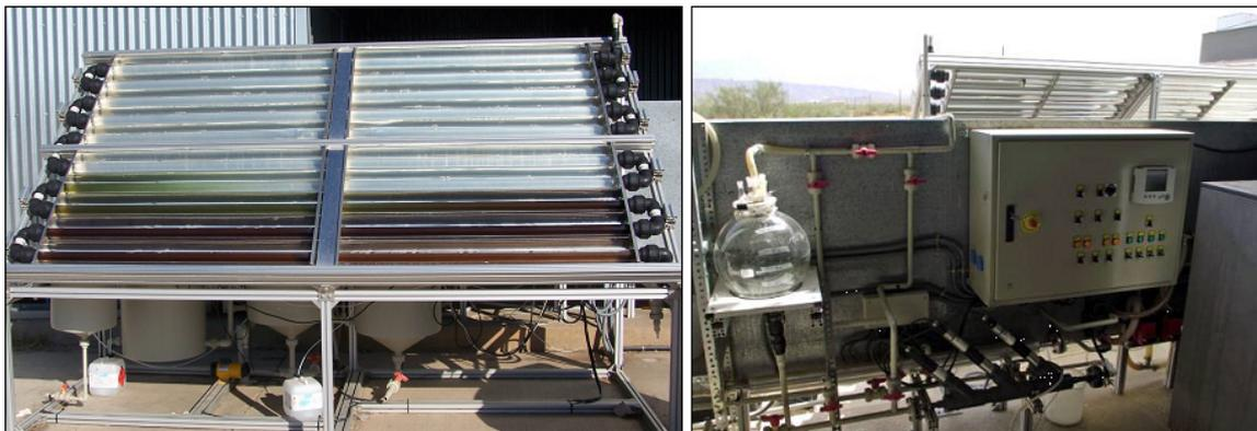
Figura 3.6. Fotografía de los cuatro módulos de captadores CPC durante un ensayo de foto-Fenton (izda.) e interior de la caseta que protege al tanque de recirculación, los sensores, el sistema de calefacción y refrigeración y el cuadro eléctrico (dcha.).
