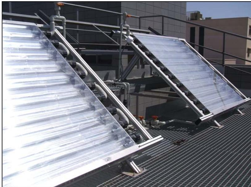
Figura 3.8. Fotografía de los dos CPC soportados sobre un armazón de aluminio inclinado 37°.
