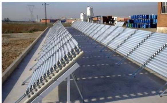
Figura 1.14. Planta experimental industrial de fotocátalisis solar (Arganda del Rey, Madrid).
