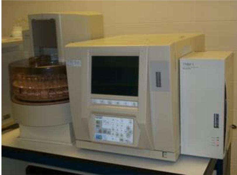
**Figura 3.1** Fotografía del analizador de carbono orgánico total Shimadzu TOC-VCSN con el sistema TNM-1 instalado en el laboratorio de la PSA.
