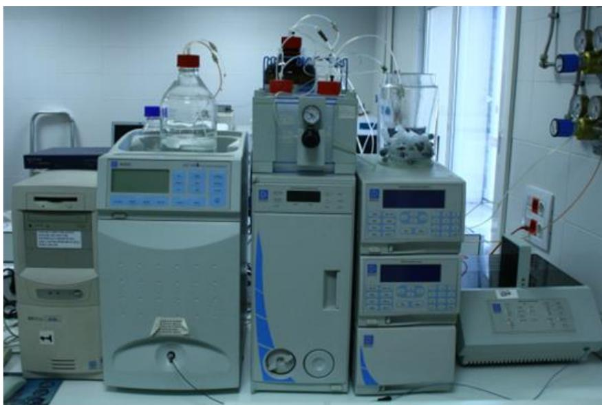
**Figura 3.3** Fotografía de los cromatógrafos iónicos DX120 y DX600 disponibles en el laboratorio de la PSA.
