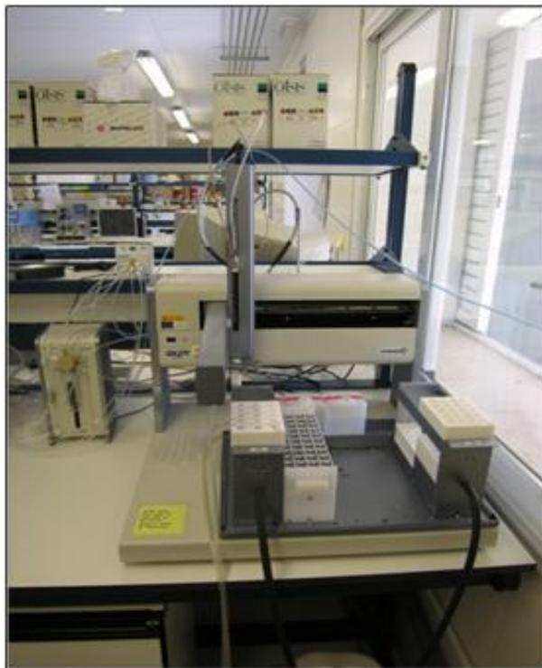
**Figura 3.5 Fotografía del equipo de extracción en fase sólida automática ASPEC**
