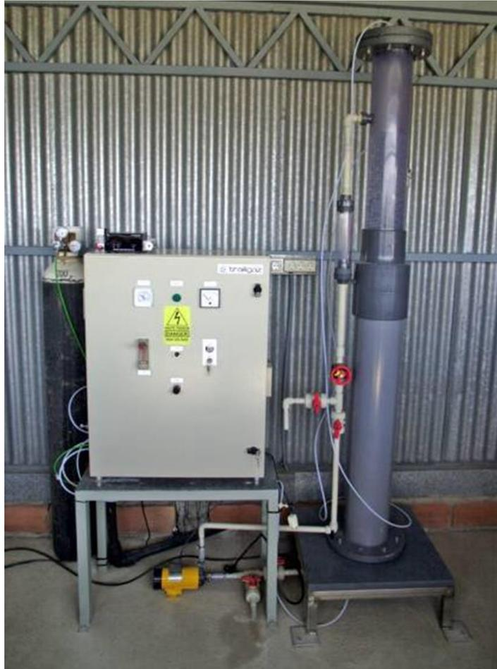
**Figura 3.24** Fotografía de la planta-piloto de ozonación instalada en la PSA.
