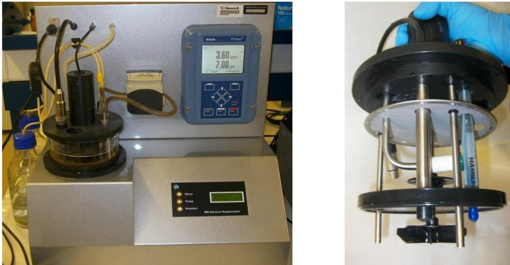
**Figura 3.11** Fotografía del Respirómetro BM-Advance instalado en el laboratorio de análisis de aguas de la PSA y detalle de los elementos del equipo (derecha).
