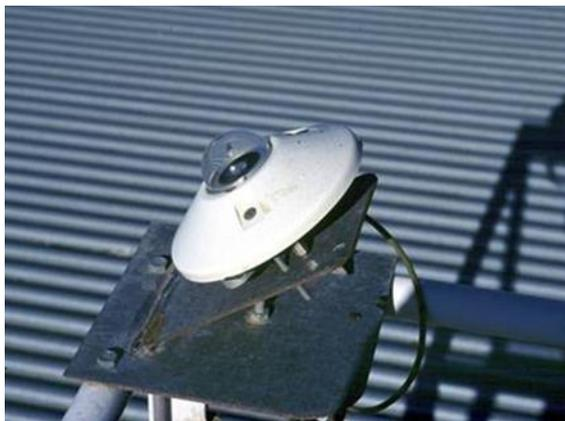
**Figura 3.9 Fotografía del radiómetro de UV global empleado en los ensayos realizados en la PSA.**
