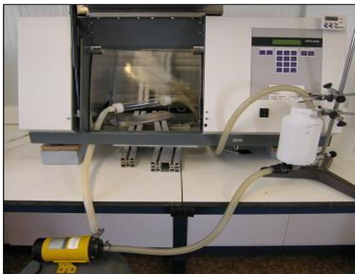
**Figura 3.20 a) Esquema del equipo a escala de laboratorio: 1. Cámara interior y lámpara de Xenón del simulador solar; 2. foto-reactor; 3. Radiómetro portátil; 4. bomba centrífuga; 5. Vaso de recirculación. b) Fotografía del sistema.**
