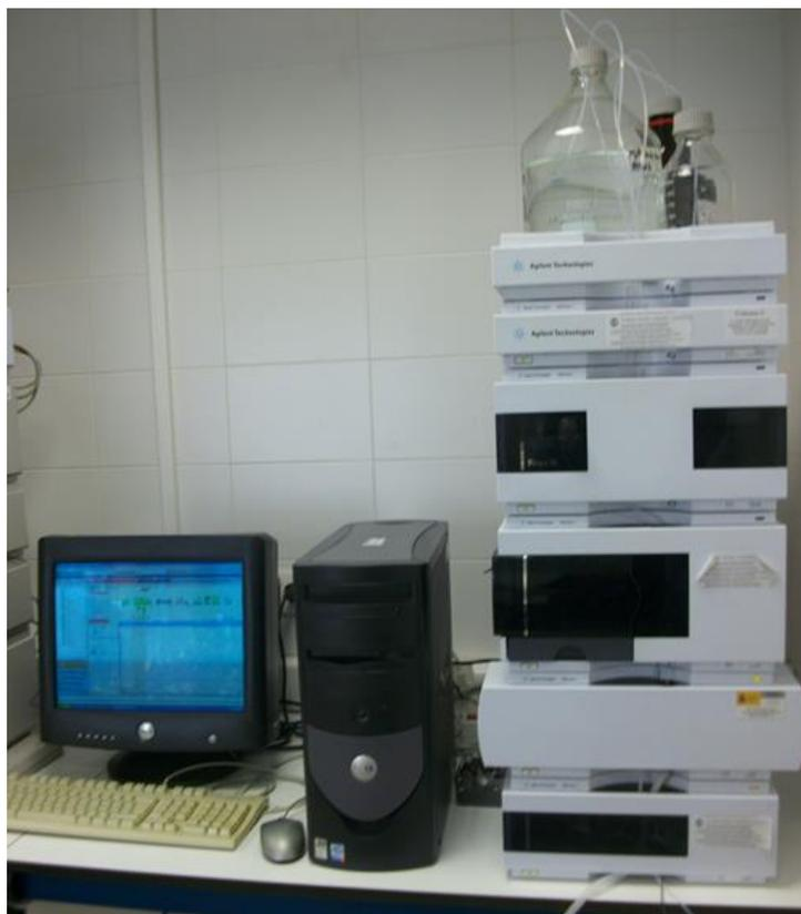
**Figura 3.2** Fotografía del sistema UPLC – DAD (Agilent 1200).
