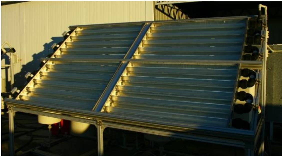
**Figura 3.23 Fotografía del fotorreactor CADOX instalado en la PSA.**
