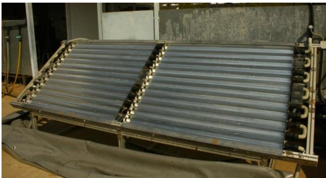
**Figura 3.22 Fotografía del fotorreactor SOLEX instalado en la PSA.**
