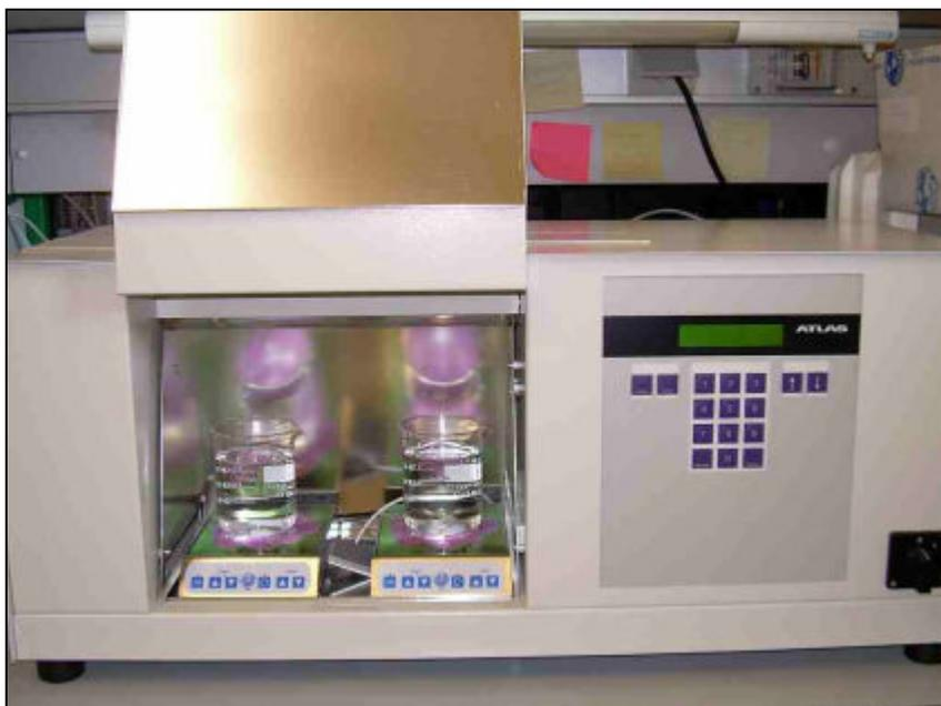
**Figura 2.8** Simulador solar Suntest CPS+ utilizado en los experimentos de fotólisis.
