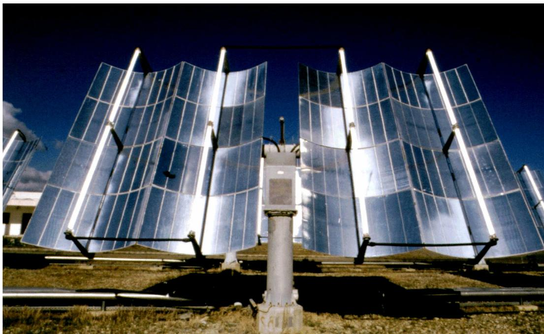
**Figura 1.11** Colector cilindro-parabólico instalado en la PSA.
