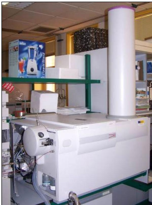
**Figura 2.5** Foto ilustrativa del sistema TOF-MS Agilent utilizado para la determinación de los PT generados.
