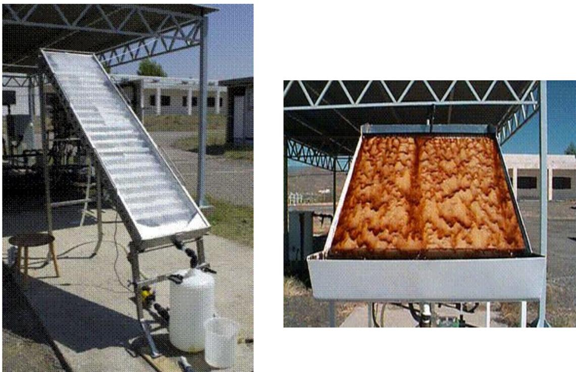
**Figura 1.12** Colectores sin concentración utilizados para degradación de contaminantes mediante FH (izquierda) y FF (derecha), desarrollados en la PSA.
