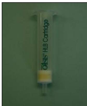
**Figura 2.2** Fotografía de un cartucho utilizado en SPE.
