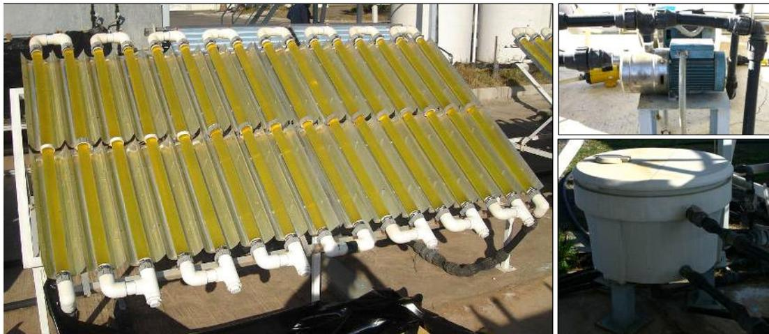
**Figura 2.10** Fotografía de un módulo del fotorreactor CPC con capacidad para tratar 450L de agua (izquierda). En el detalle, fotografía de la bomba (derecha, superior) y del tanque (derecha, inferior).
