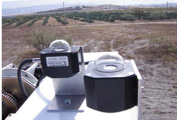
Figura 2.20 Sondas del espectrorradiómetro para medida de la radiación global y difusa dispuestas en el seguidor solar
