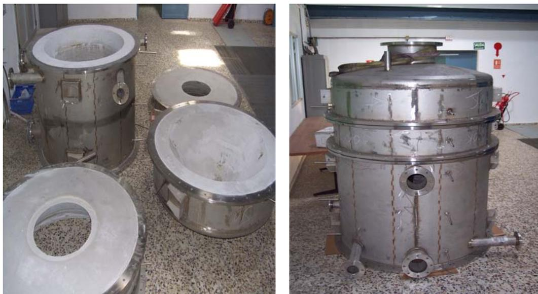
Figura 3.22 Despiece del receptor solar SYNPET con aislamiento cerámico
