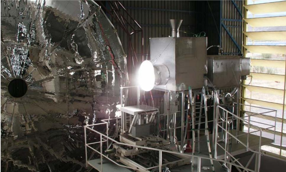
Figura 3.27 Reactor lecho fluidizado en operación en el Horno Solar de PSA
