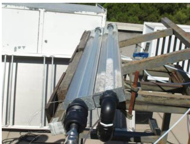
Figura 4.12 Colector Parabólico Compuesto para los ensayos con radiación solar, situado en la azotea del edificio (CIEMAT).
