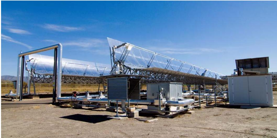
Figura 3.6 Vista del lazo experimental construido en la PSA en el año 2007 para investigar el uso de fluidos de trabajo innovadores en colectores cilindro-parabólicos.
