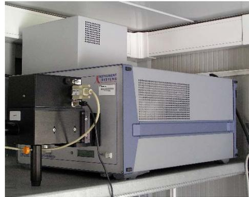
Figura 2.21 Detector del espectrorradiómetro con el *switcher* de conexión de las tres sondas
