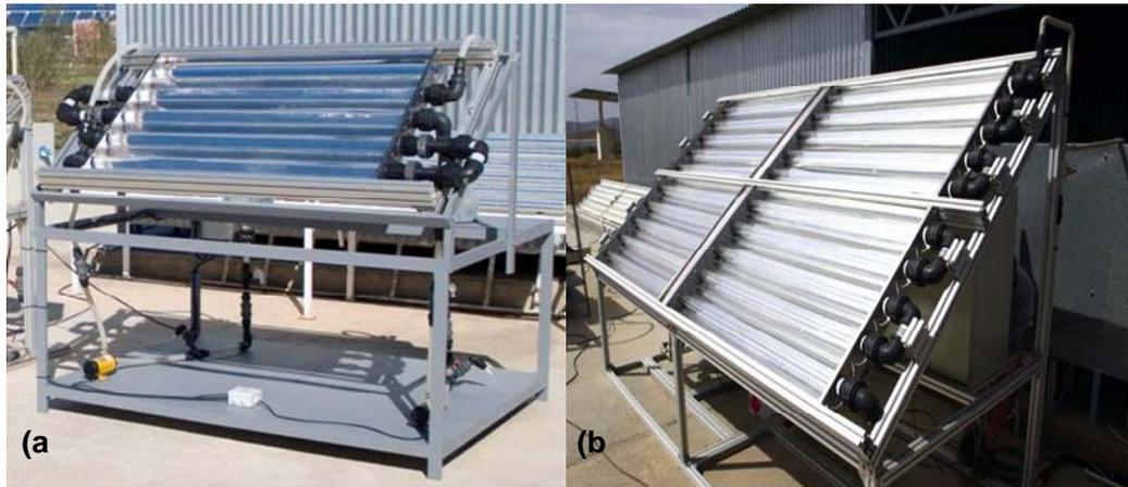
Figura 4.4 Prototipos de fotorreactor solar para desinfección de agua de 14 L (a) y de 70 L (b).
