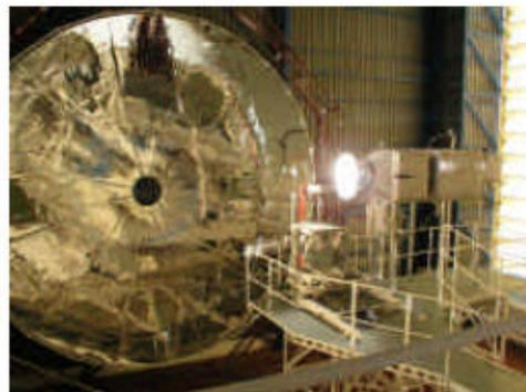
Figura 3.15 Ensayo de envejecimiento sobre absorbedor volumétrico de SiC. Con objeto de analizar el deterioro microestructural de este tipo de material se elevó la concentración sobre el absorbedor hasta que aparecieron pequeñas muestras de fundido de dicho material a temperatura superficial de unos 1500°C
