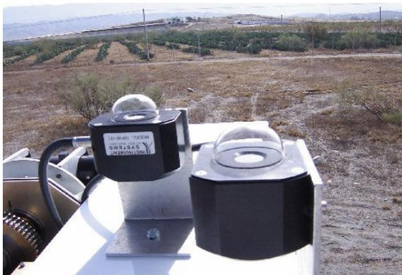
Figura 2.18 Sondas del espectrorradiómetro para medida de la radiación global y difusa dispuestas en el seguidor solar
