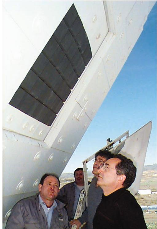
Figura 2.4 Vista frontal del banco de ensayos de receptores volumétricos en la torre CRS, en el rango de 200-350 kW.
