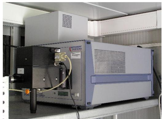
Figura 2.19 Detector del espectrorradiómetro con el switcher de conexión de las tres sondas
