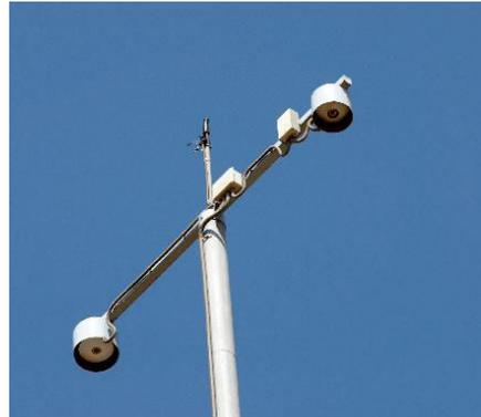
Figura 4.18 Efectos producidos por la caída de un rayo. El anemómetro que se encontraba en lo alto del mástil fue derribado.
