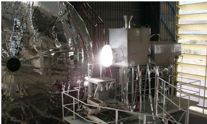
Figura 3.26 Reactor lecho fluidizado en operación en el Horno Solar de PSA
