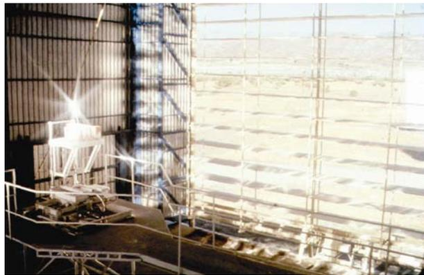
Figura 2.13 El foco y la mesa de ensayos, a la izquierda de la foto. A la derecha, el atenuador totalmente abierto permite el paso de los rayos procedentes de los helióstatos, situados en el exterior
