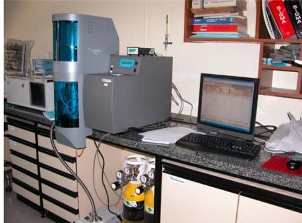
Figura 3.16 Sistema de análisis termogravimétrico para análisis de comportamiento de los materiales sometidos a la acción combinada de temperatura elevada y de los ciclos de temperatura, en atmósfera controlada.
