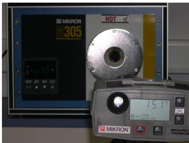
Figura 3.20 Calibración de detector IR en laboratorio.
