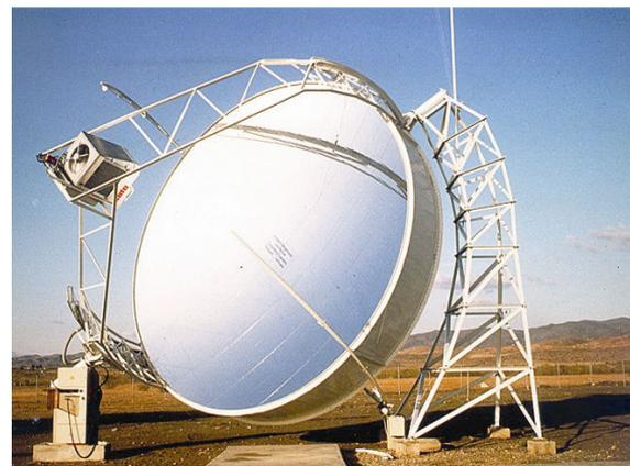
Figura 2.9 Un sistema DISTAL I en operación en la Plataforma Solar de Almería
