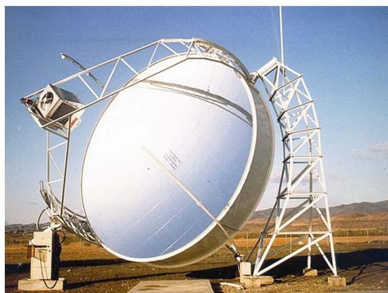
**Figura 16. Un sistema DISTAL I en operación en la Plataforma Solar de Almería**
