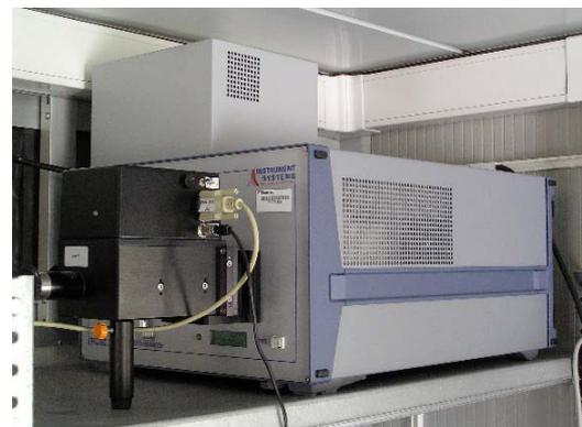
**Figura 29.** Detector del espectrorradiómetro con el switcher de conexión de las tres sondas
