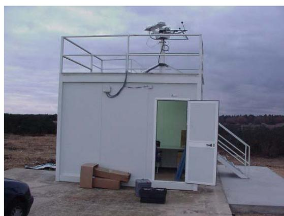
**Figura 32. Estación radiométrica en el CEDER (Soria)**
