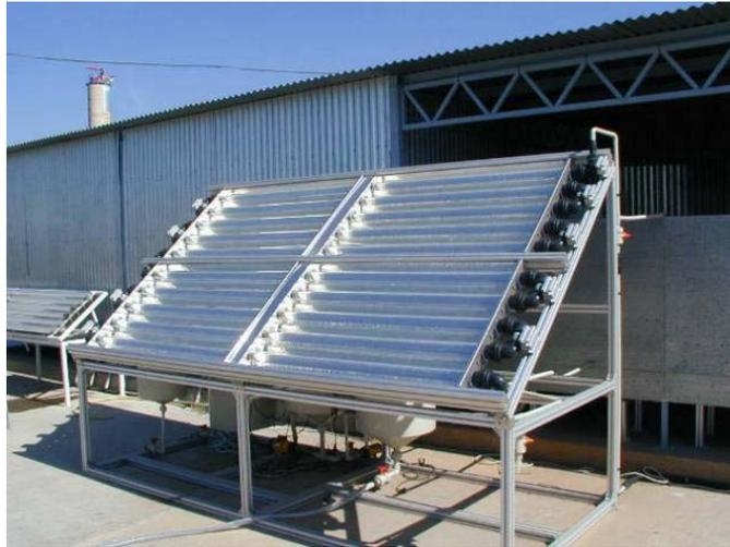
**Figura 72. Nuevo colector CPC desarrollado en proyecto CADOX para aplicaciones con foto-Fenton.**
