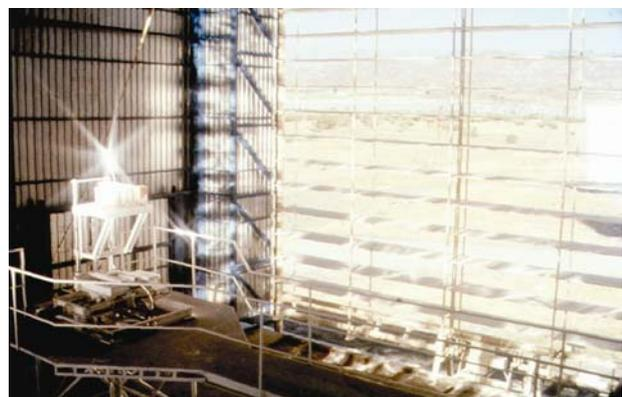
**Figura 20. El foco y la mesa de ensayos, a la izquierda de la foto. A la derecha, el atenuador totalmente abierto permite el paso de los rayos procedentes de los helióstatos, situados en el exterior**
