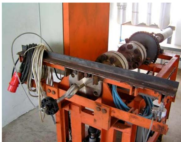
**Figura 60. Vista de la máquina de ensayos para juntas rotativas en la planta DISS de la PSA.**
