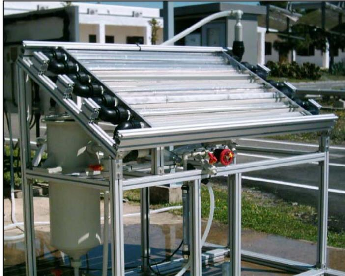
**Figura 76. Prototipo de captador solar para aplicaciones de desinfección de agua con catalizador fijado sobre una placa plana dispuesta verticalmente en el interior del tubo de vidrio**
