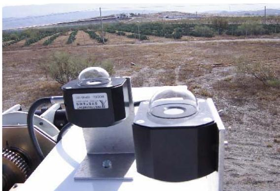
**Figura 28.** Sondas del espectrorradiómetro para medida de la radiación global y difusa dispuestas en el seguidor solar
