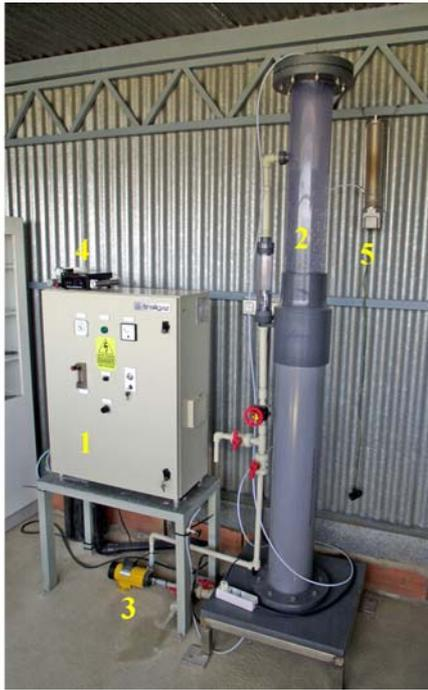
**Figura 67. Vista del sistema de ozonización instalado en la Plataforma Solar de Almería. 1, Generador de ozono. 2, Columna de contacto. 3, Bomba recirculación. 4, Analizador de ozono. 5, Destructor de ozono.**
