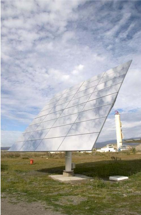
Figura 22 Nuevo heliostato GM-140
