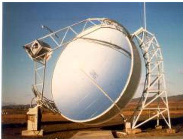
Figura 16 Un sistema DISTAL I en operación en la Plataforma Solar de Almería
