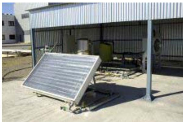
Figura 29 Vista de la plataforma de ensayo de colectores solares estáticos
