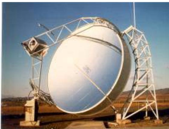
Figura 17. Un sistema DISTAL I en operación en la Plataforma Solar de Almería
