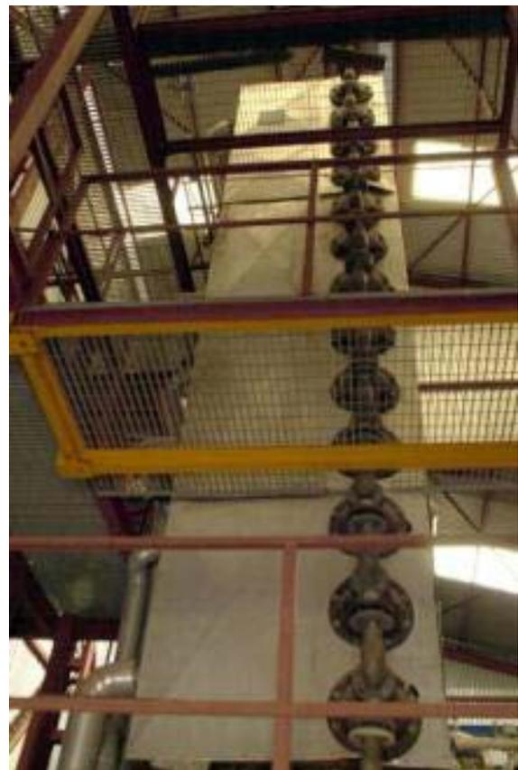
**Figura 61. Planta de destilación multiefecto de la PSA con un total de 14 efectos**
