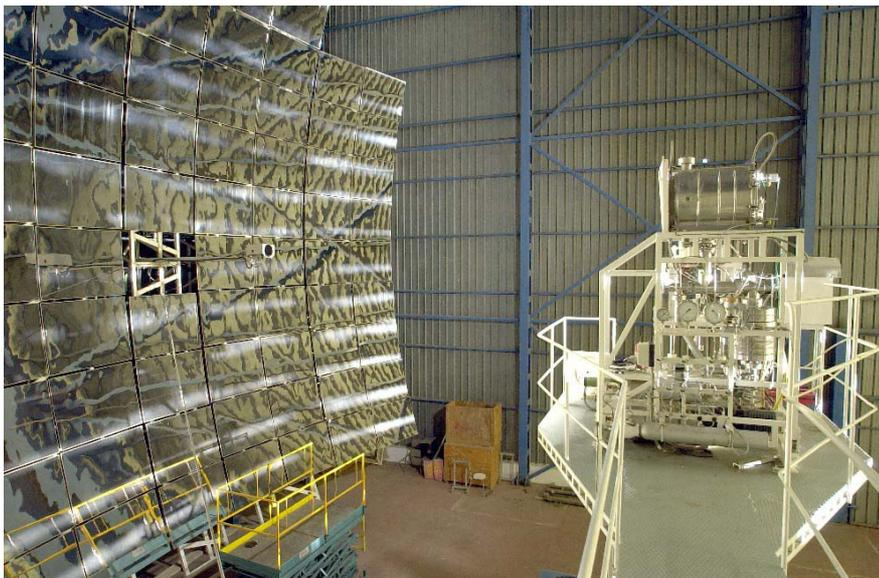
**Figura 69. Concentrador parabólico y cámara de vacío**
