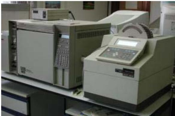
**Figura 25. a) Sistema GC-MS para el análisis de muestras en discontinuo**
