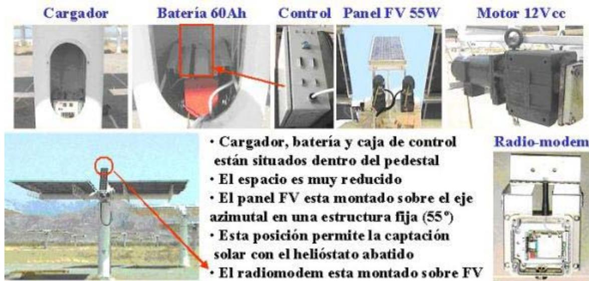
**Figura 33. Prototipo de heliostato autónomo en el campo CRS y detalle de los componentes desarrollados dentro del proyecto PCHA**
