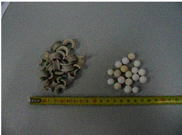
**Figura 36. Bolas de alúmina utilizadas con anterioridad en la instalación TSA (derecha) y nuevo material propuesto para el núcleo con forma de silla de montar (izquierda).**
