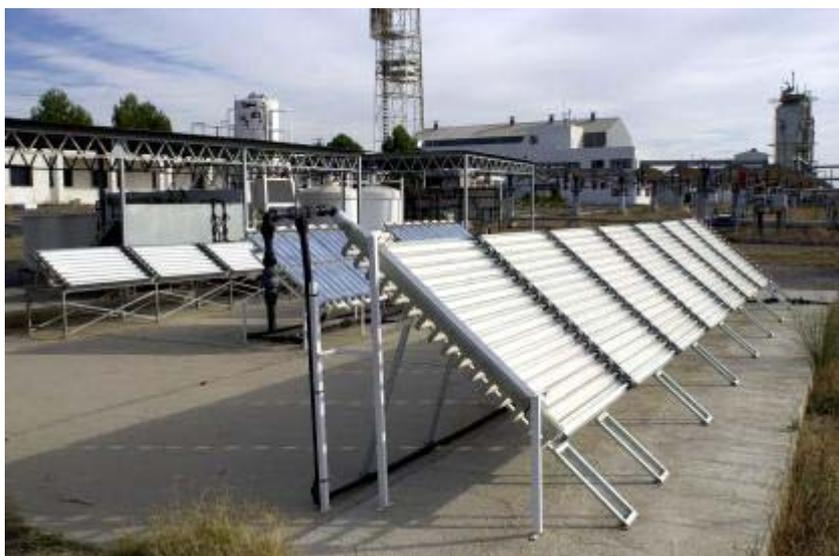
**Figura 23.** Vista general de las instalaciones para aplicaciones de Fotoquímica Solar basadas en colectores CPC con el nuevo colector en primer plano.
