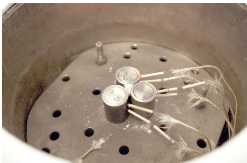
Piezas del HUT dentro de la cámara de vacío, antes de su tratamiento térmico mediante luz solar concentrada
