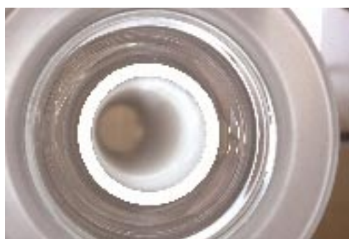
Catalizador tubular impregnado con \text{TiO}_2 y alojado en el interior del adsorbente de un colector cilindroparabólico. La configuración del sistema permite utilizar radiación solar en su parte externa a la vez que lámparas UV irradian la superficie interna del catalizador
