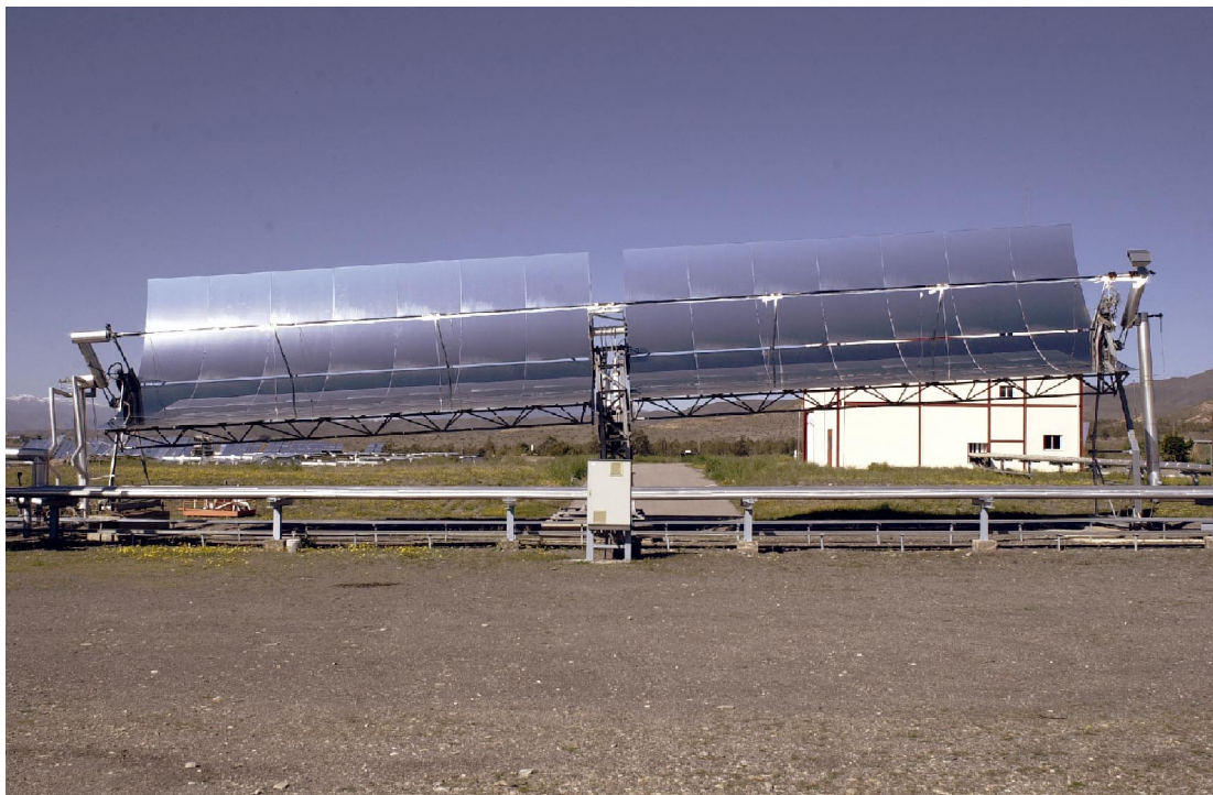
Aspecto del colector número 9 del lazo DISS tras ser inclinado 4°
