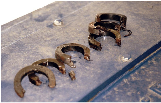
Aspecto que presentaban las empaquetaduras y los vástagos de la bomba de recirculación tras una de las frecuentes averías
