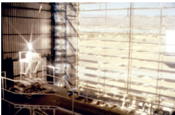
El foco y la mesa de ensayos, a la izquierda de la foto. A la derecha, el atenuador totalmente abierto permite el paso de los rayos procedentes de los helióstatos, situados en el exterior
