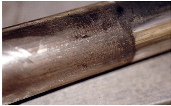
Aspecto que presentaban las empaquetaduras y los vástagos de la bomba de recirculación tras una de las frecuentes averías
