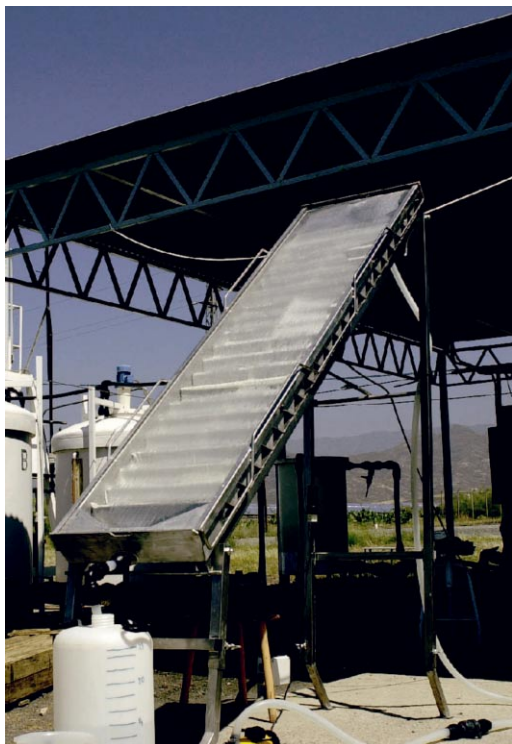
Fotoreactor "en cascada" utilizado para ensayar titanía depositada sobre un soporte de fibra preparada por la empresa AHLSTROM PAPER
