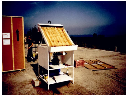
Fotorreactor "mixto" basado en colector CPC y lámparas UV instalado en almazara en Portugal (izquierda) y fotorreactor basado en "placa plana" instalado en almazara en Grecia (derecha)
