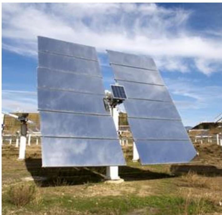
Figura 25. Un heliostato autónomo en el campo SSPS-CRS.
