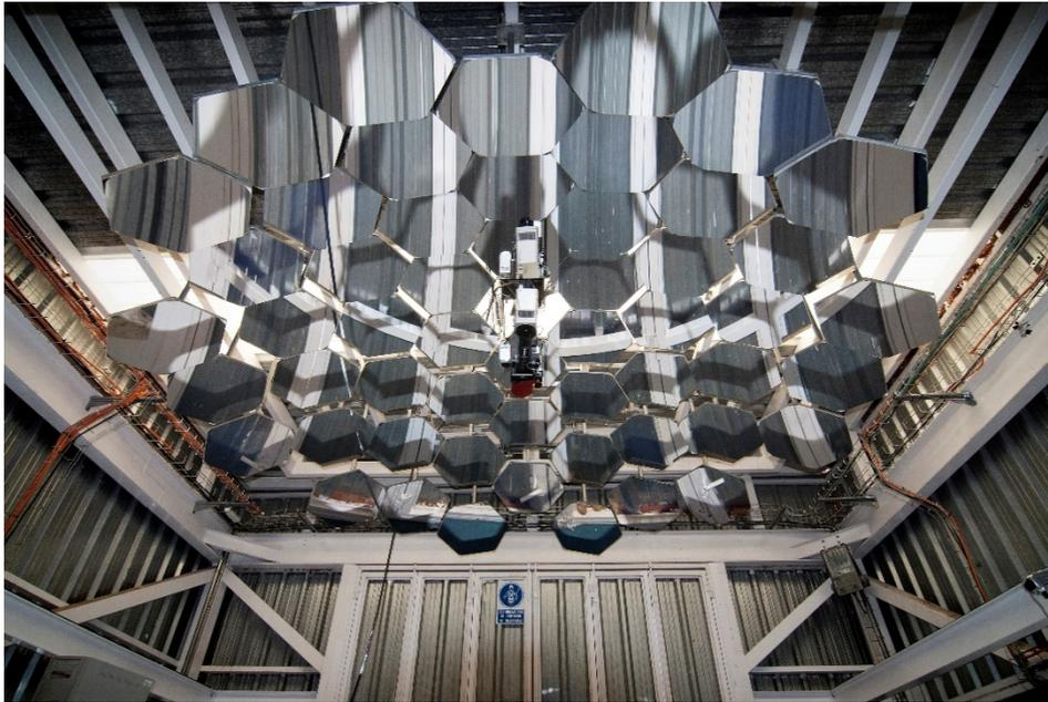
Figura 32. Captador del horno solar SF-5.
