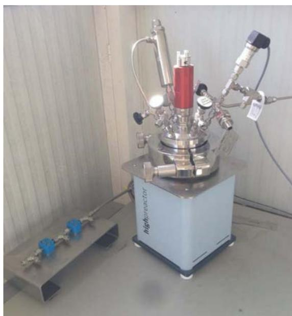
Figura 50. Planta piloto de oxidación por aire húmedo
