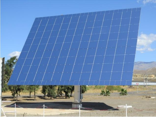
Figura 27. Heliostato HT120 en seguimiento.
