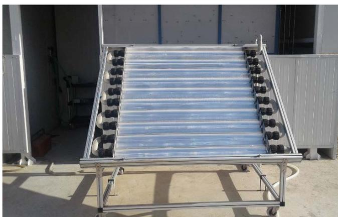
Figura 44. Vista de un CPC 2 m<sup>2</sup> (ELECTROX) acoplado a planta piloto Electro-Fenton.
