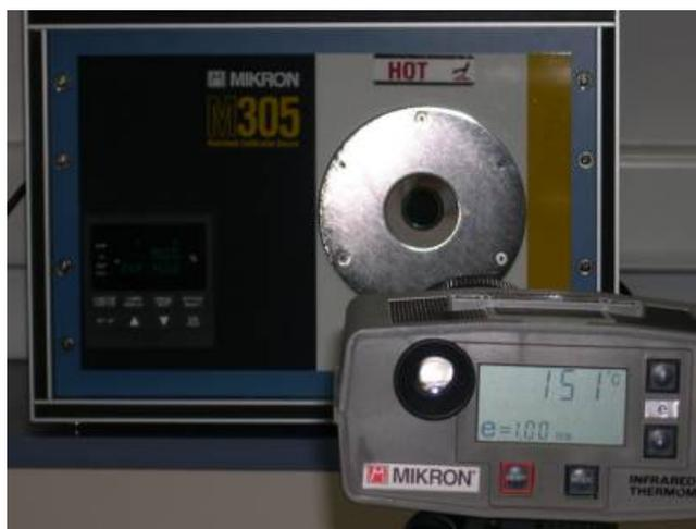
Figura 62. Sensor de calibración IR utilizando un cuerpo negro.
