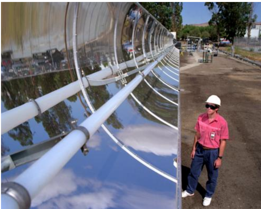
Figura 3. Colector cilindro-parabólico adaptado para fotocátalisis solar. Experiencia realizada por National Renewable Energy Laboratory en Livermore (California) en 1991 para el tratamiento de agua contaminada por tricloroetileno. Foto por cortesía de NREL (USA).
