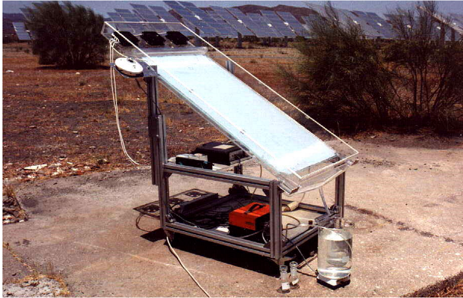
Figura 16. Instalación experimental de un colector de placa plana utilizado por el ISFH (Institut für Solarenergieforschung GmbH, Hannover, Alemania) en las instalaciones de la PSA.
