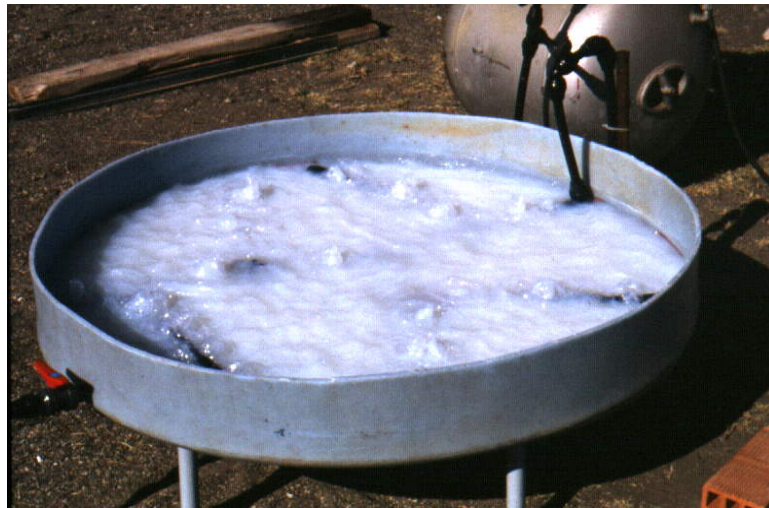
Figura 19. Instalación experimental de un colector tipo balsa superficial ensayándose en la Plataforma Solar de Almería (CIEMAT, España).
