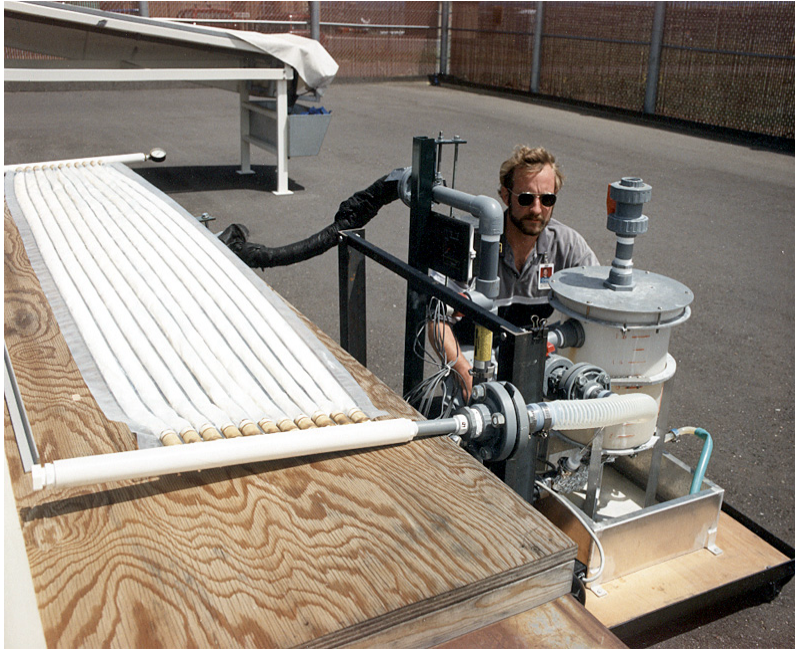
Figura 18. Colector tubular experimental desarrollado por NREL (National Renewable Energy Laboratory, Denver, USA). Foto por cortesía de NREL (USA).
