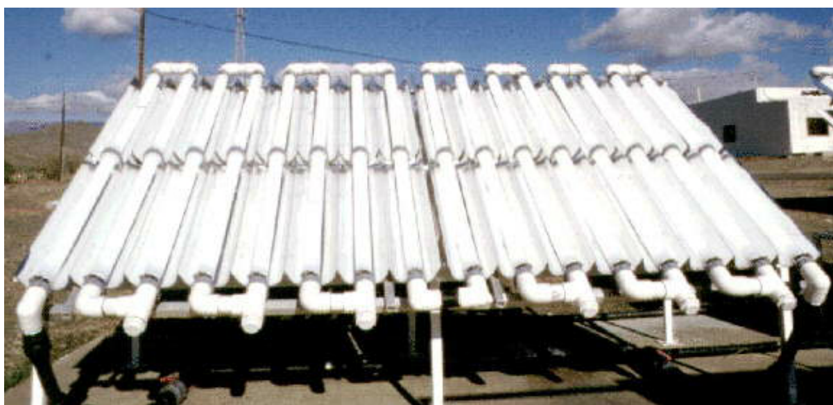
Figura 22. Colector cilindro-parabólico compuesto (CPC) sin concentración solar ( C = 1 ) para aplicaciones de Fotocátalisis Solar (Plataforma Solar de Almería).
