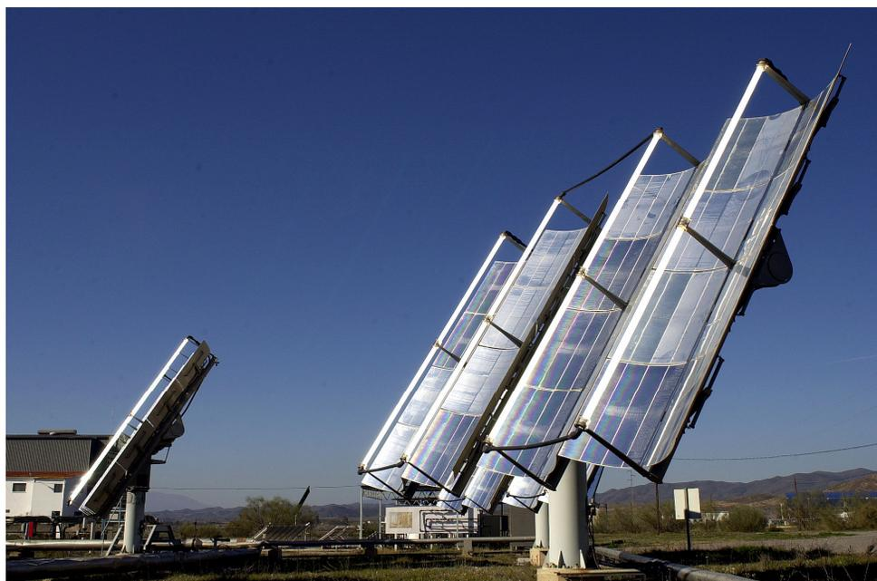
Image 1 : PTC de la PSA doté d'un système de suivi du soleil à deux axes, [CIEMAT]
