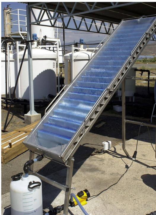
Image 2 : collecteur à non-concentration de type cascade testé à la PSA, [CIEMAT]
