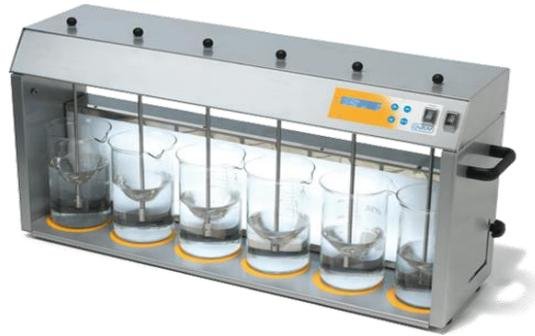
**Figura III.22.** Sistema Jar-test disponible en el laboratorio.
