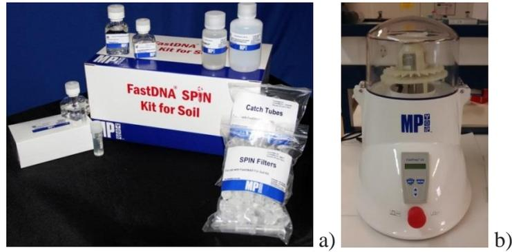
**Figura III.9.** a) Kit comercial utilizado para la extracción de ADN (FastDNA™ SPIN Kit for Soil) b) FastPrep® utilizado para favorecer la extracción del ADN.
