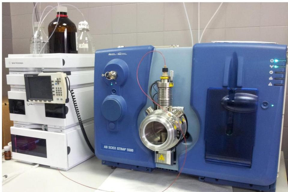
**Figura II.12.** Sistema 5500 Q-TRAP<sup>®</sup> LC-MS-MS utilizado.
