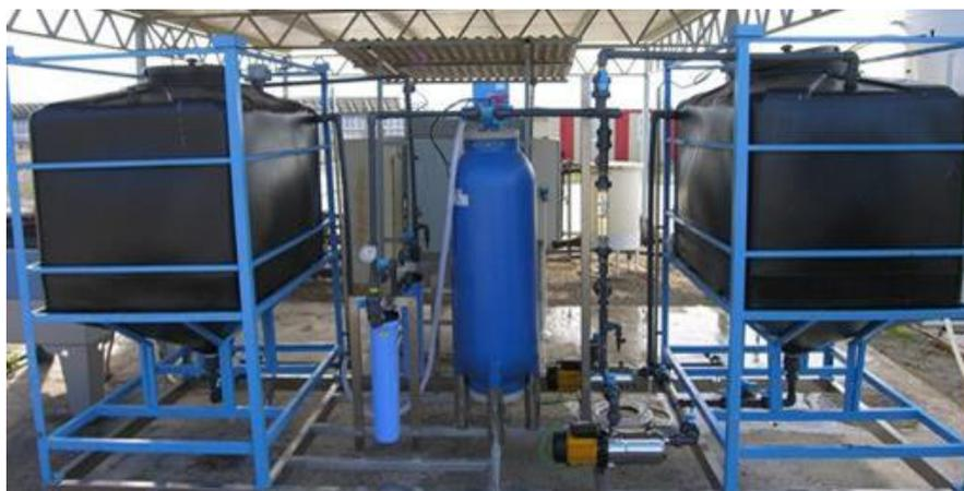
**Figura III.23.** Fotografía del sistema de coagulación/floculación/filtración disponible en la PSA.
