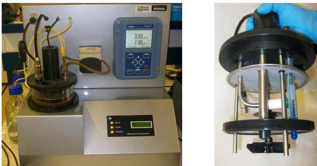
**Figura III.13.** Fotografía del respirómetro BMT-Advance instalado en el laboratorio.
