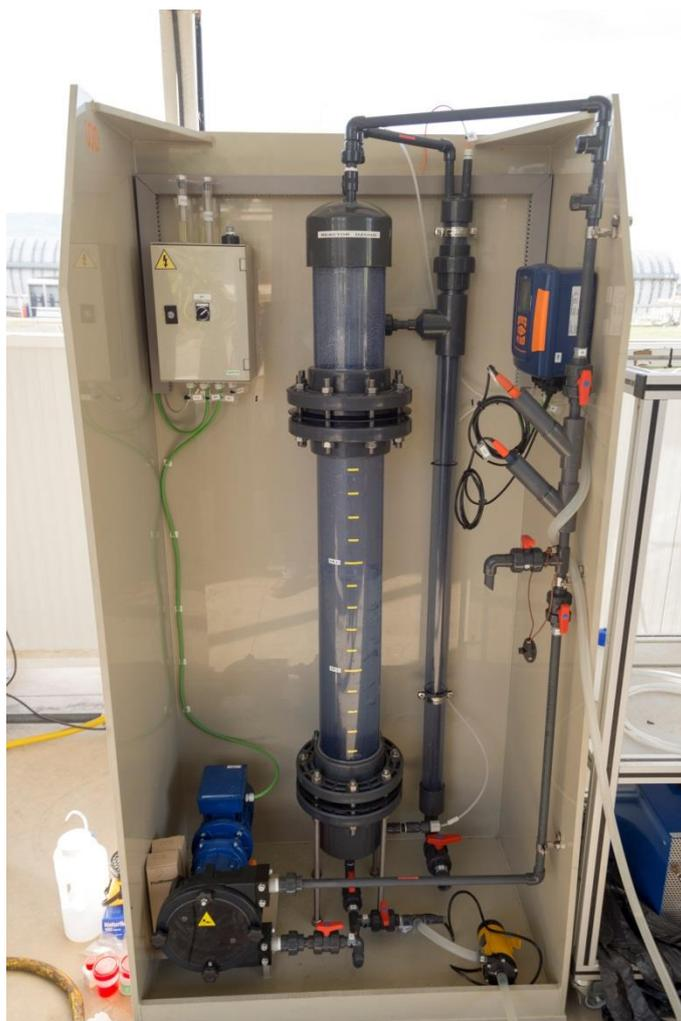
**Figura III.26.** Fotografía de la planta piloto de ozonización utilizada.
