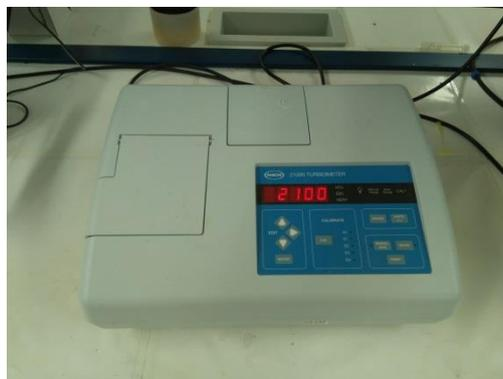
**Figura III.2:** Turbidímetro Hach modelo 2100N.
