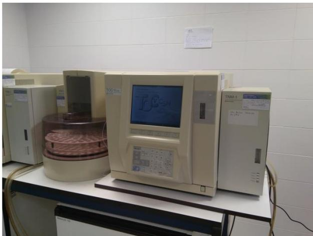
**Figura III.6.** Analizador de carbono orgánico total Shimadzu TOC-VCSN con el sistema TNM-1 utilizado en este trabajo.
