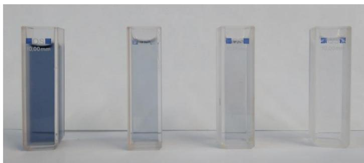
**Figura III.4.** Coloración de muestras en función de la concentración de polifenoles utilizando el reactivo de Folin-Ciocalteu.
