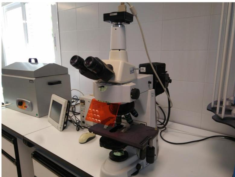
**Figura III.8.** Microscopio óptico Nikon Eclipse 50i acoplado a una cámara Nikon DS utilizado en este estudio.
