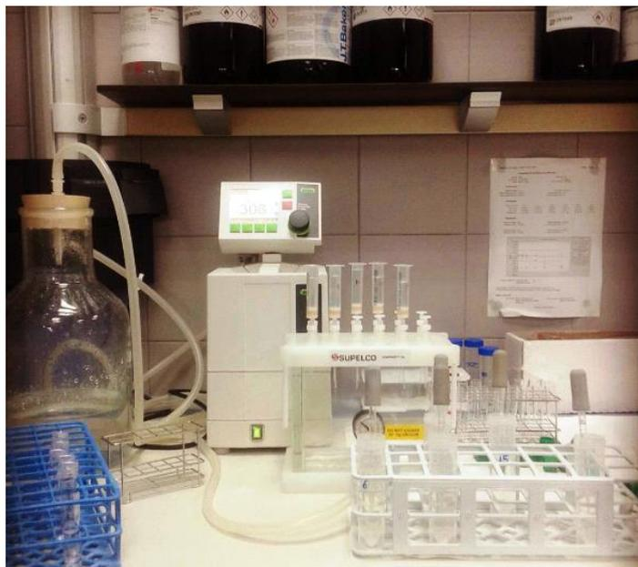
**Figura II.6.** Sistema de extracción manual utilizado para todas las extracciones SPE y SSPE.
