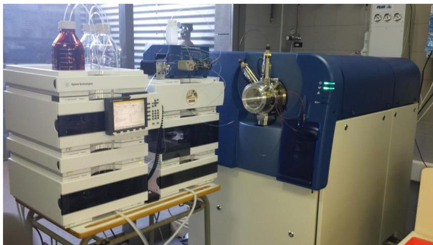
**Figura II.14.** Sistema LC-ESI-QTOF-MS utilizado en este trabajo.
