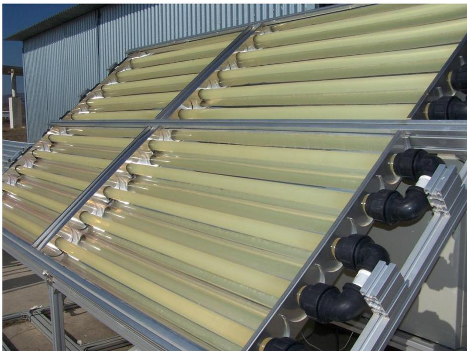
**Figura III.25.** Fotografía del captador CPC utilizado para reacciones de foto-Fenton solar.
