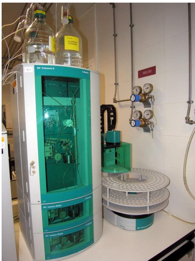
**Figura III.7.** Fotografía del cromatógrafo iónico módulo de Metrohm IC850 y Metrohm 858.
