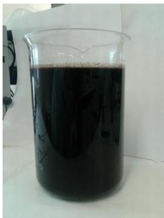
**Figura III.27.** Agua residual de cocido de corcho utilizada.
