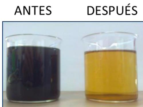
**Figura III.39.** Agua residual de cocido de corcho antes y después del pre-tratamiento físico-químico con  $\text{FeCl}_3$ .
