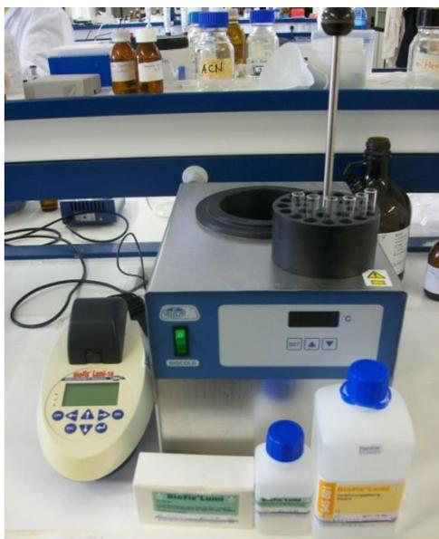
**Figura III.15.** Termoblock, Luminómetro Biofix®Lumi-10, kit BioFix®Lumi “Multi-shot” (solución reconstituyente, viales de bacteria liofilizada y solución salina 2% de NaCl 20g/L).
