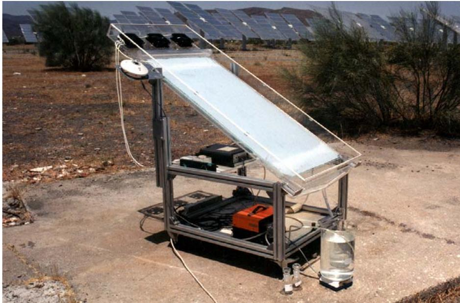
*Figura 1.3.11.* Instalación experimental de un colector de placa plana utilizado por el ISFH (Institut für Solarenergieforschung GmbH, Hannover, Alemania) en las instalaciones de la PSA.
