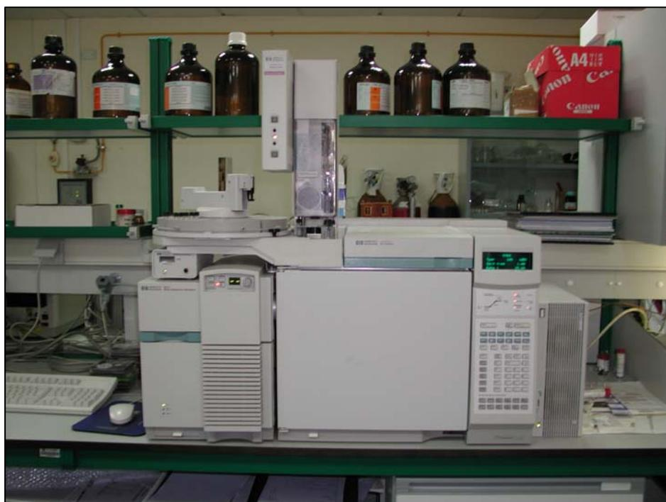
*Figura 2.3.5.* Fotografía de cromatógrafo de gases acoplado a detector de masa, GC/MS, instalado en el laboratorio de investigación del Departamento de Química Analítica de la Universidad de Almería.
