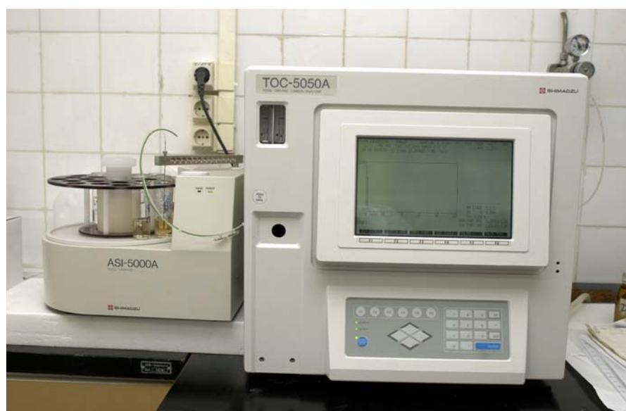
*Figura 2.2.1.* Fotografía del Analizador de Carbono Orgánico Total Shimadzu 5050A instalado en el laboratorio de la Plataforma Solar de Almería.
