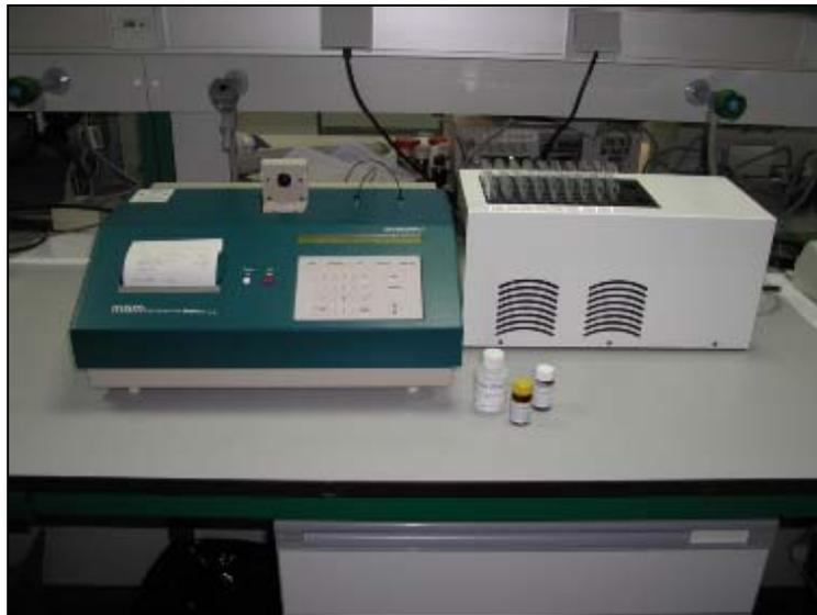
Figura 2.4.6. Luminómetro, incubador y kit Biotox™
