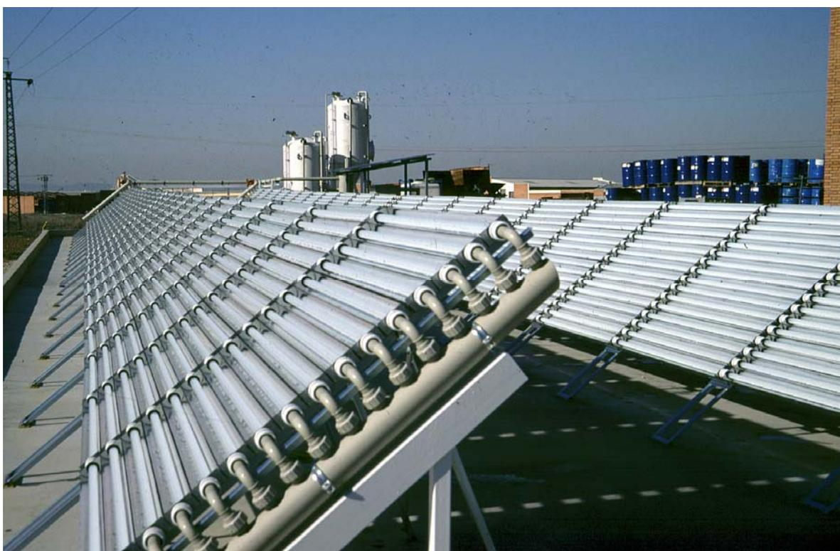
*Figura 6.3.5.* Fotografía de una planta de tratamiento fotocatalítico solar de plaguicidas.
