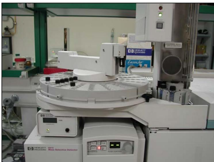
*Figura 2.3.6.* Fotografía del inyector automático del GC/MS instalado en el laboratorio de investigación del Departamento de Química Analítica de la Universidad de Almería.
