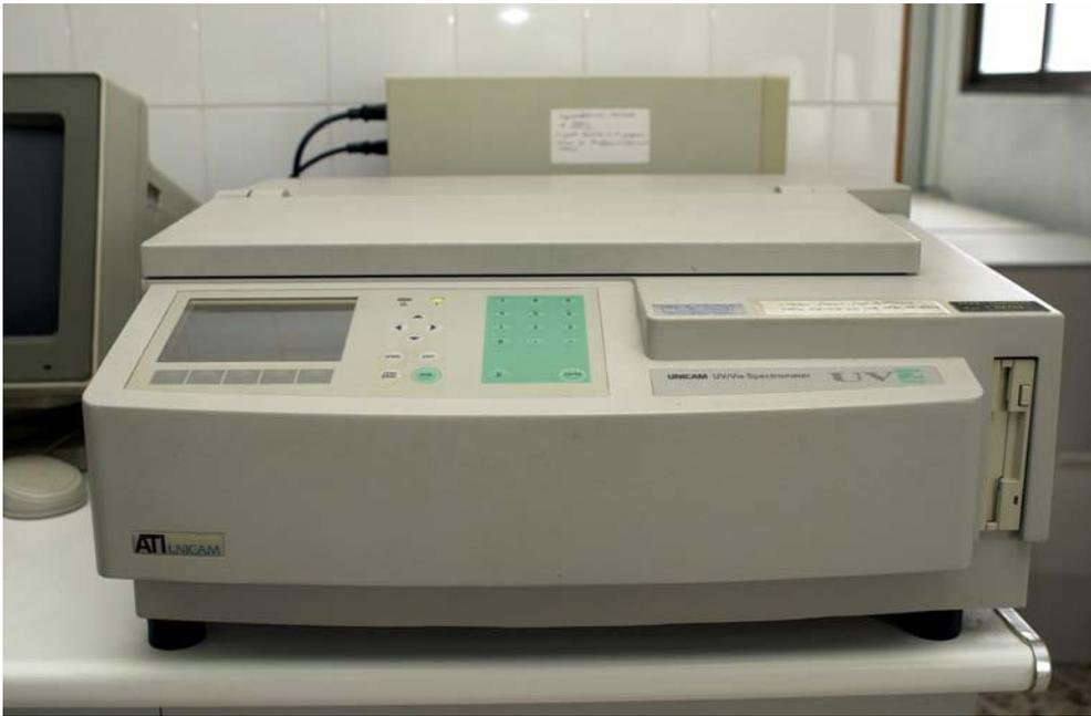
*Figura 2.2.8.* Fotografía del espectrofotómetro Unicam del laboratorio de la PSA.
