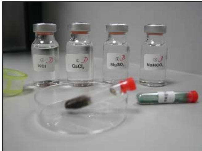
Figura 2.4.2. *Daphtoxkit*<sup>TM</sup>, bioensayo basado en la movilidad de *Daphnia magna*
