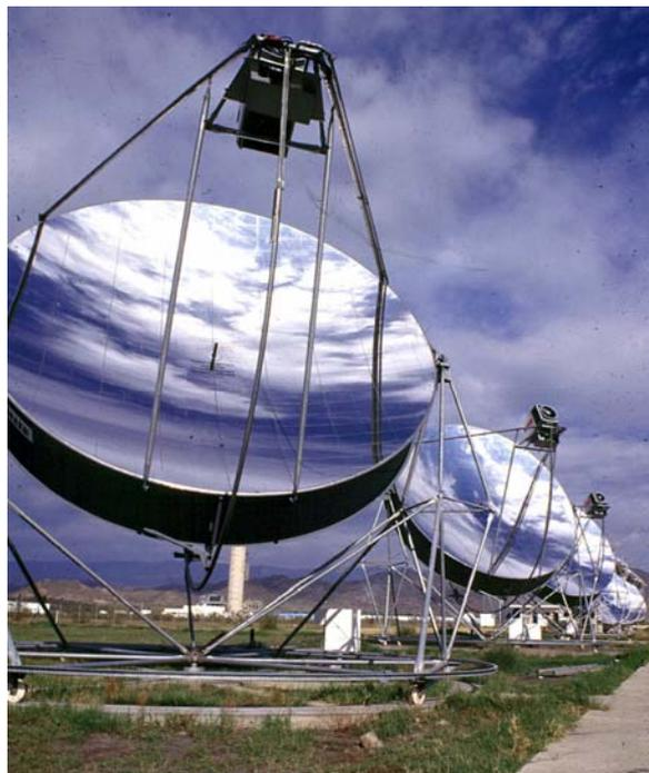
*Figura 1.3.8.* Colector solar de alta concentración.
