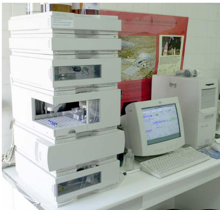
*Figura 2.2.2.* Fotografía del HPLC (Agilent Technologies serie 1100), instalado en el laboratorio de la Plataforma Solar de Almería.
