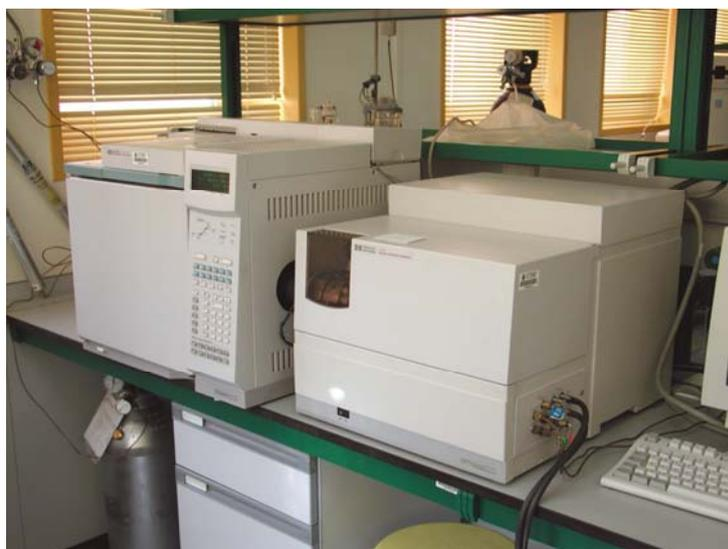
*Figura 2.2.7.* Fotografía del Cromatógrafo de Gases con Detector de Emisión Atómica, GC-AED, instalado en el laboratorio de investigación del Departamento de Química Analítica de la Universidad de Almería
