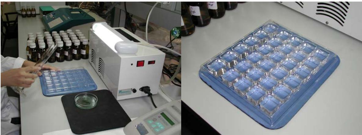
Figura 2.4.3. Fotografía de las placas de pocillos para medidas de toxicidad aguda con *Daphnia Magna*.
