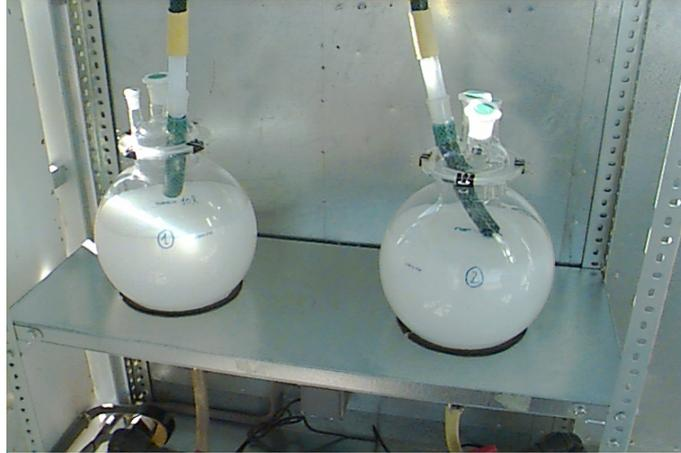
Figura 2.1.6. Fotografía de los tanques del reactor CPC en la planta piloto.
