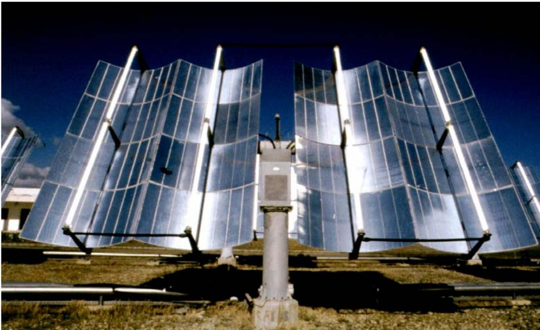
*Figura 1.3.9.* Colector cilindro-parabólico con seguimiento en dos ejes instalado en la PSA.
