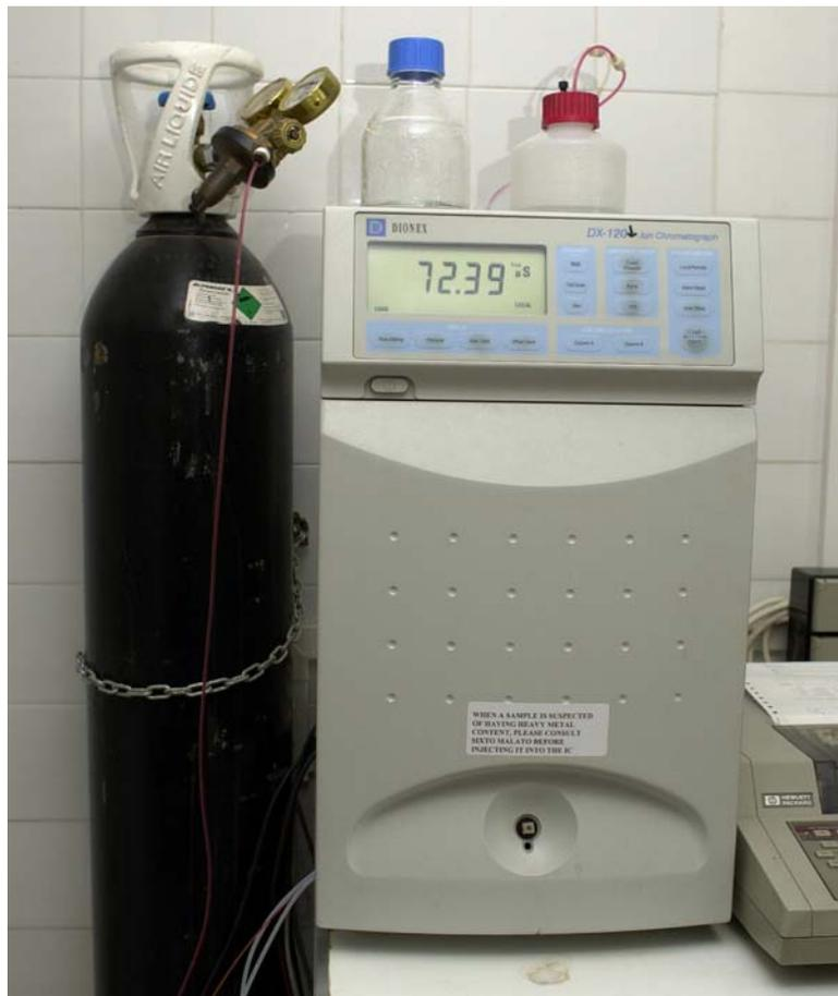
*Figura 2.2.5.* Fotografía del Cromatógrafo Iónico DIONEX-120, instalado en el laboratorio de la Plataforma Solar de Almería (PSA).
