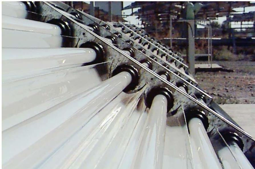
*Figura 1.3.13.* Detalle de un colector CPC donde se observa la configuración de los tubos reactores.
