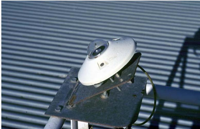
Figura 2.1.8. Fotografía del Radiómetro de UV global utilizado en esta Tesis Doctoral.
