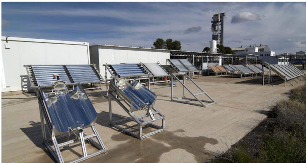
Figura 1.15. Vista general de los foto-reactores CPC en las instalaciones de la PSA.
