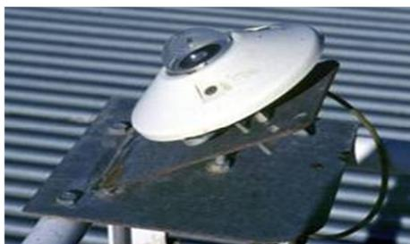
**Figura 3.14.** Foto de un radiómetro en las instalaciones de la PSA inclinado  $37^\circ$  sobre el plano horizontal.
