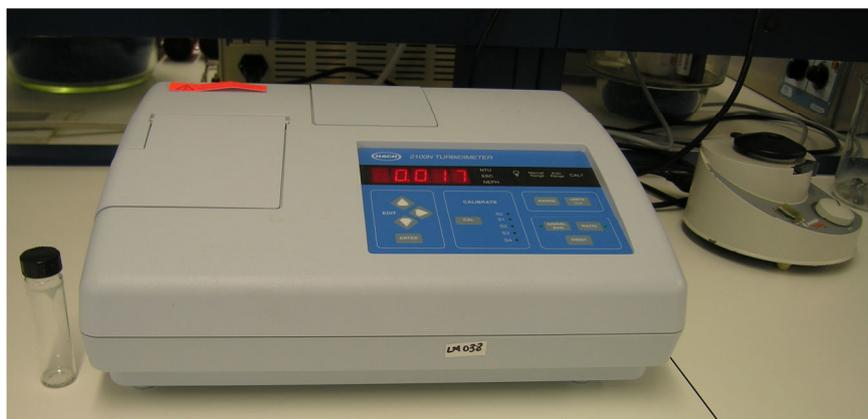
**Figura 3.9.** Turbidímetro modelo 2100AN utilizado en el procedimiento experimental.
