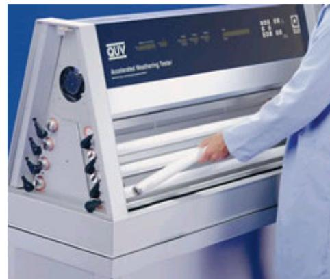
Figure 2.25. Cámara climática y detalle de los tubos de radiación UV-B
