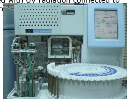
Figure 2.41. Equipo ATD-GC-MS para análisis de contaminantes en el aire interior
